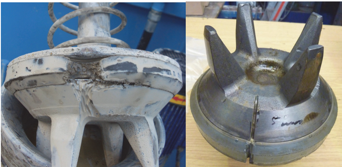
Bild 2: Verschleißbild der Ventile im Bohrbetrieb (links) und für Laborversuch (rechts)
