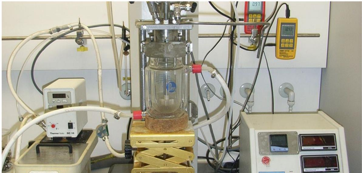
**Abbildung 2.5-2:** Foto des Versuchsaufbaus für die Reaktivextraktion
