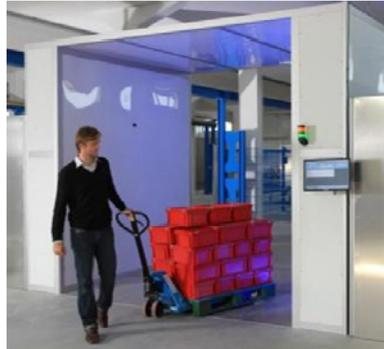
Abbildung 12: links - RFID-Tunnel für Frachtfingerprint Paket; rechts - RFID-Gate für Frachtfingerprint Palette
