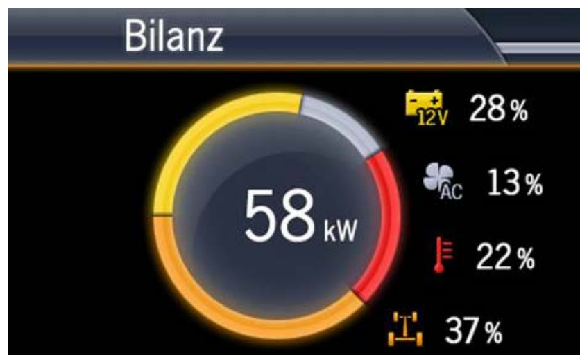
Abbildung 68: Darstellung des Energiehaushalts
