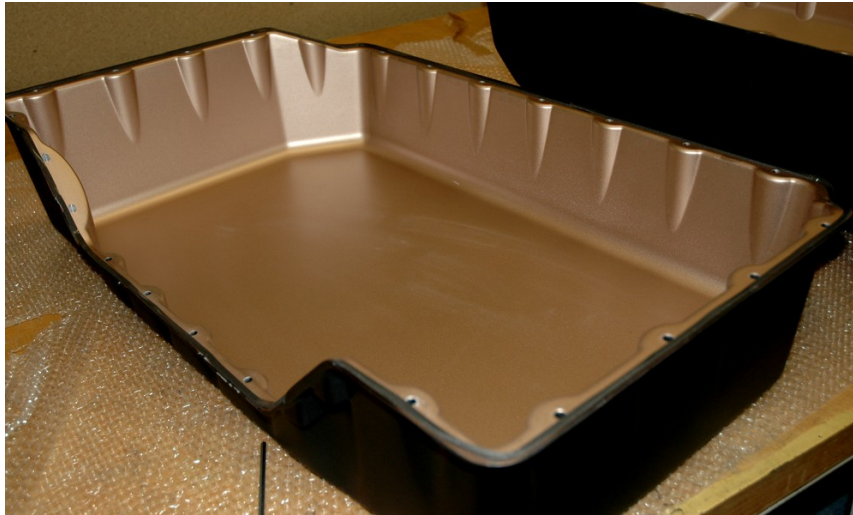
Abbildung 42: EMV Beschichtung aus leitfähigem Lack
