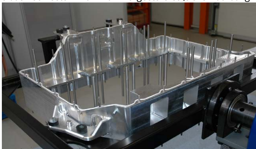
Abbildung 41: Der zentrale Tragrahmen aus Aluminium
