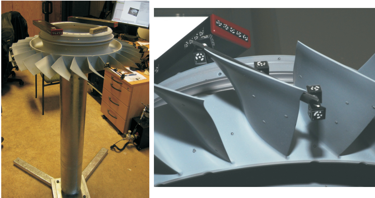
Abbildung 8.2: Links: Installation der Blisk auf einer beweglichen Vorrichtung; Rechts: codierte und uncodierte Referenzmarken auf der beschichteten Blisk
