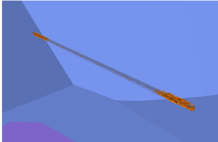
Abb. 5.23 10%-Isofläche der Porosität 60 Jahre nach Einlagerung
