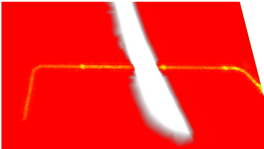
Abb. 5.5 Kriechkompaktion im Versatz der verfüllten Strecke
