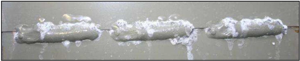
Bild 63: AZ31-Steppnaht mit KTL nach 3 Wochen
