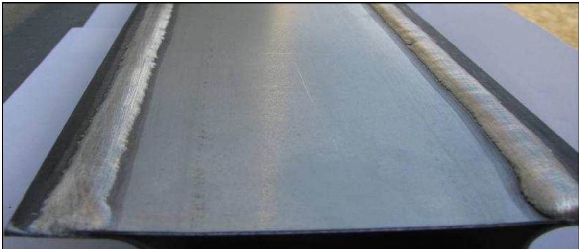
Bild 74: Funktionsmuster DC04 auf 22MnB5-Profil mit Lot AZ31
