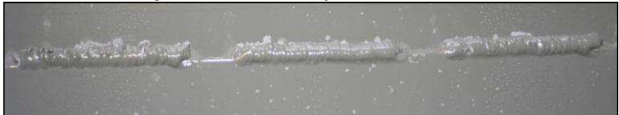
Bild 32: AlSi3Mn-Steppnaht mit KTL nach 3 Wochen
