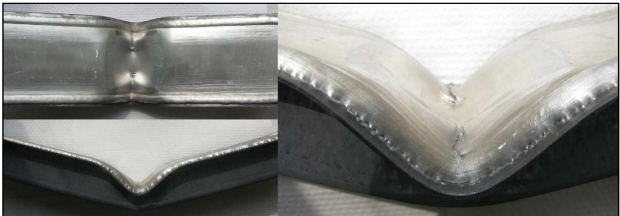
Bild 77: 22MnB5/AZ31 + AZ31 nach der 3Punktbiegung
