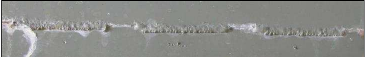
Bild 35: AlSi3Mn-Steppnaht mit KTL nach 12 Wochen
