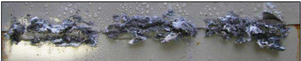
Bild 64: AZ61-Steppnaht mit KTL nach 6 Wochen
