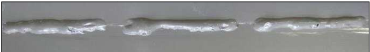
Bild 44: ZnAl5Cu3,5-Steppnaht nach 6 Wochen
