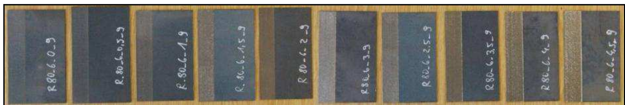
Bild 18: Abtrag der Schichten (links geringer Abtrag; rechts Abtrag bis zum blanken Blech)
