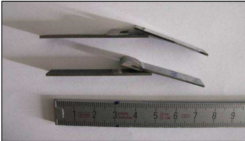
Bild 58: Verbindungsversagensorte (oben 22MnB5- DX53+Z; unten 22MnB5- AZ31)
