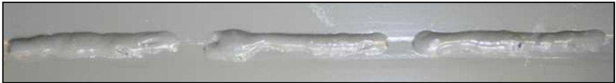
Bild 43: ZnAl5Cu3,5-Steppnaht nach 3 Wochen
