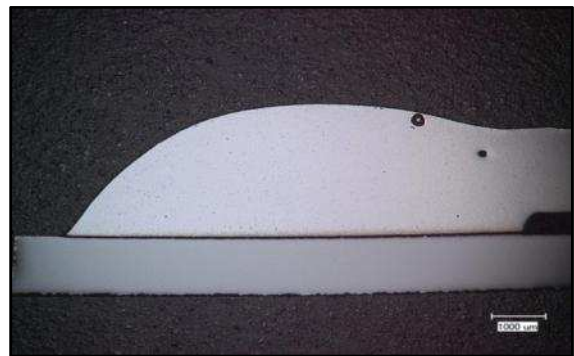
Bild 60: Schliff: AZ31 auf 22MnB5, SZ:AZ61 (gestrahlt)
