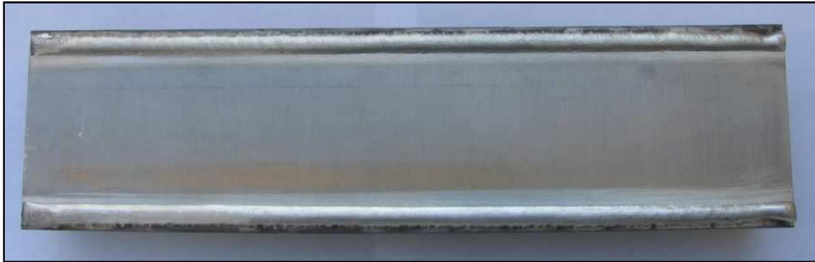
Bild 73: Funktionsmuster AZ31 auf 22MnB5-Profil mit Lot AZ31
