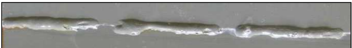
Bild 46: ZnAl5Cu3,5-Steppnaht nach 12 Wochen
