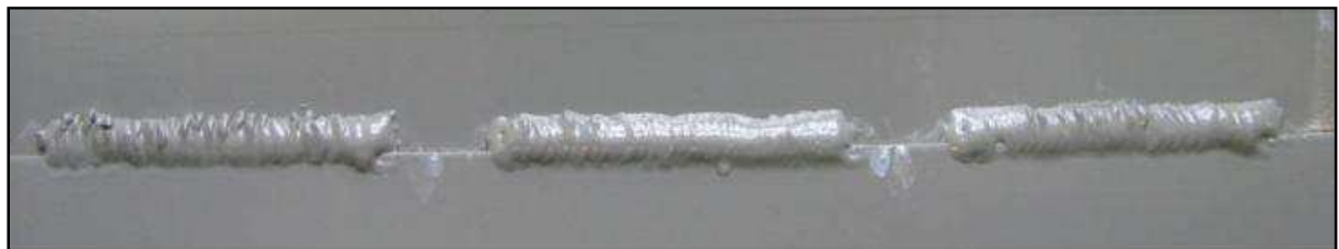
Bild 33: AlSi3Mn-Steppnaht mit KTL nach 6 Wochen
