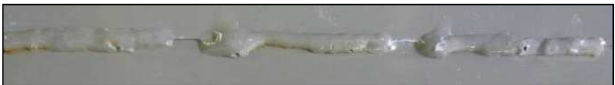
Bild 45: ZnAl5Cu3,5-Steppnaht nach 9 Wochen
