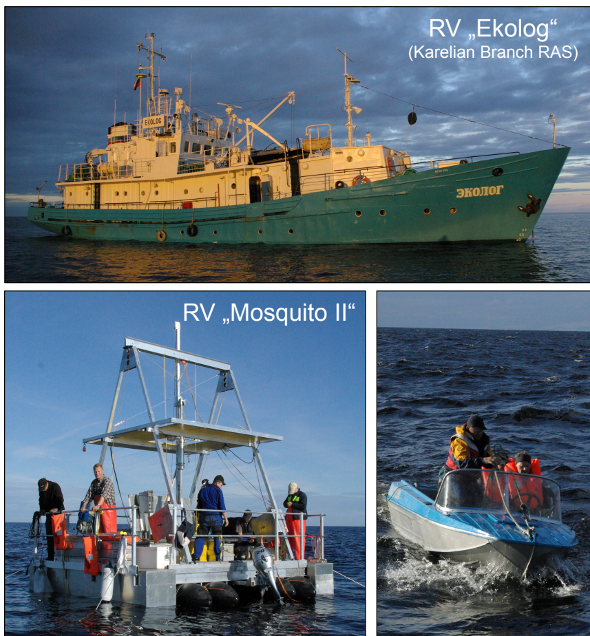
Abb. 6: Die Bohrungen im Sept. 2013 auf dem Ladoga-See wurden mit der neuen UWITEC-Bohrtechnik von der neuen Arbeitsplattform („Mosquito II“, siehe u.I.) durchgeführt. Die Arbeiten wurden durch das Forschungsschiff „Ekolog“ des INWP, Karelian Branch der RAS (siehe oben) logistisch unterstützt, mit Shuttle-Transport zwischen Plattform und Schiff mit dem Beiboot der „Ekolog“ (siehe u.r.).
