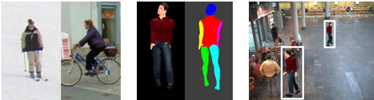
Abbildung 6: Training von Detektoren mit künstlichen Daten. Links: Bilder aus INRIA-Personendatensatz, die nicht für ein Flughafenszenario geeignet sind. Mitte: 3D-modellierte Person mit Ground-Truth. Rechts: Person in die Szene eingefügt.
