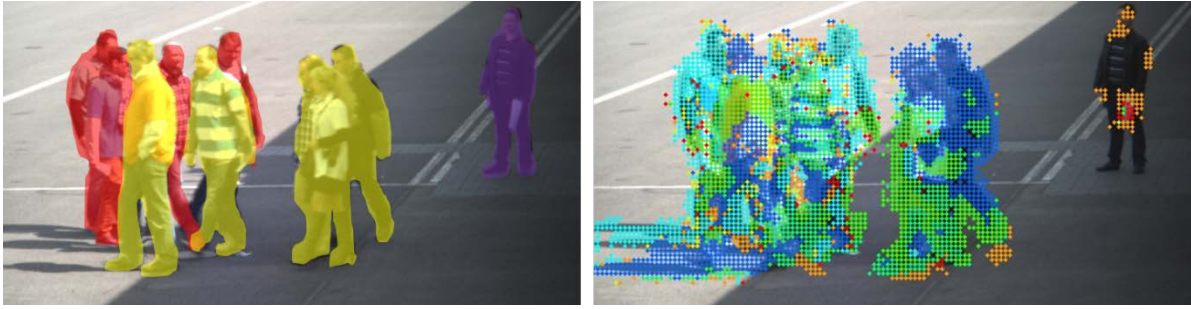
Abbildung 8: Segmentierung von Gruppen anhand der Bewegungsrichtung. Links: Segmentierung der Gruppen (vereinfachte Darstellung: Gruppierung wird eigentlich über Detektionen von Einzelpersonen anhand ähnlicher Bewegungs-Cluster vorgenommen). Rechts: Zu Grunde liegendes Clustering der Bewegungen (Gruppe 1: vorwiegend blau, grün dargestellte Bewegung nach links, Gruppe 2: cyan dargestellte Bewegung nach rechts, Gruppe 3: stehende Person; Bewegung orange dargestellt)
