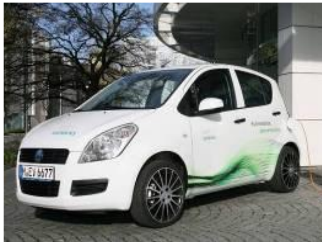
Abbildung 38: V2G-Stromos: Vollelektrische Prototypenfahrzeuge mit bidirektionaler Ladefunktionalität
