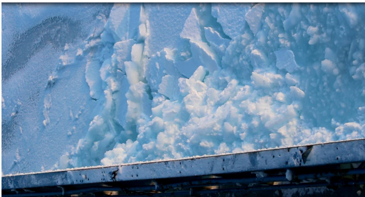
Abbildung 53 Anhaftendes Eis am Rumpf der Lance, erhöhter Widerstand durch Eiskeil
