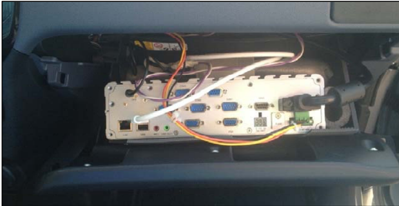
Abbildung 12-15: Eingebauter Car-PC im Handschuhfach
