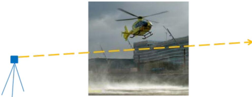
**Abbildung 52: Low-Air speed –Messung durch den downwash eines fliegenden Hubschraubers hindurch**
