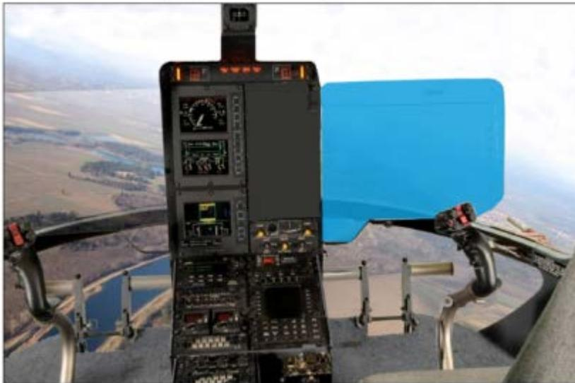
**Abbildung 6: Konzept des transparenten Displays Version 2 - Cockpitsicht**
