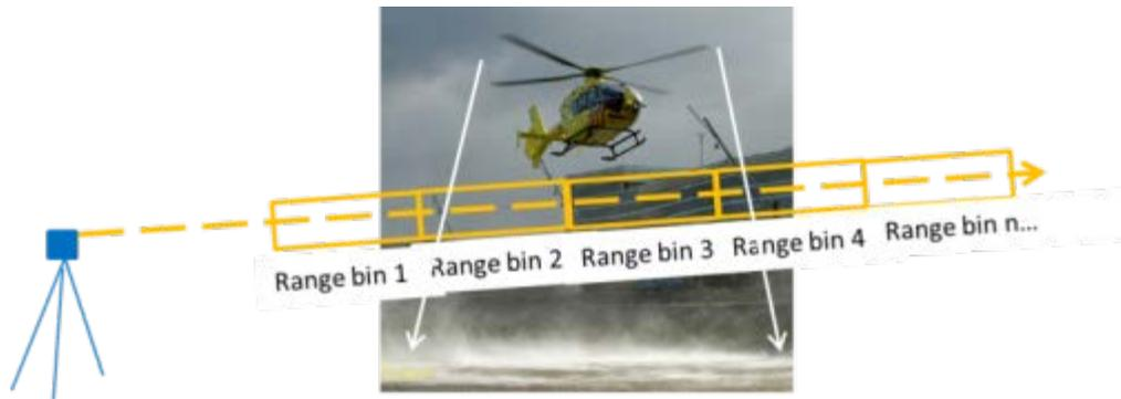
**Abbildung 53: Analyse von unterschiedlichen range bins erlaubt die Messung vor, innerhalb und hinter dem downwash**
