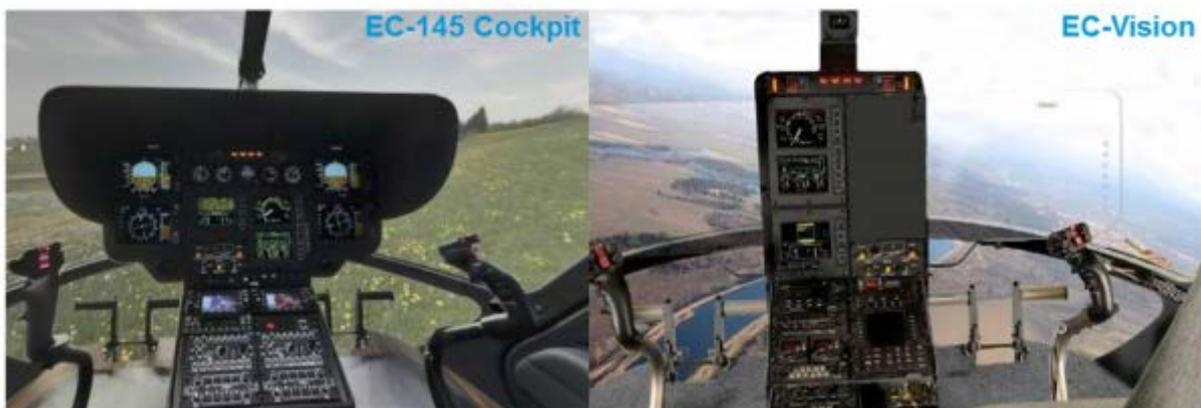
Abbildung 1: EC145 Standard Cockpit (linkes Teilbild) und EC Cockpit-Vision (rechtes Teilbild)
