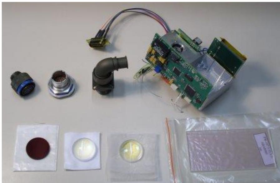
**Abbildung 31: Komponenten des Laserhöhenmessers**
