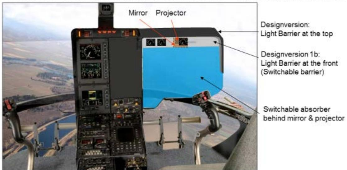
Abbildung 4: Konzept des transparenten Displays Version 1.1 - Cockpitsicht
