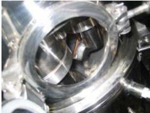
Abbildung 20: Trockenmischen aller Pastenbestandteile
