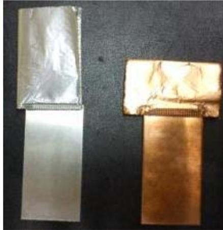
Abbildung 9: Ergebnisse US-Schweißversuche an Aluminium- (links) und Kupfer-Ableiter-Bündeln (rechts).
