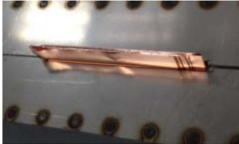
Abbildung 109: Detailaufnahme vom einwandfreien Schnittergebnis der pneumatischen Trimm-Vorrichtung
