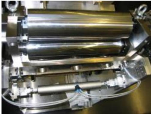
Abbildung 7: Beschichtungswerk in der Ausbauf orm eines Kommarakelsystems
