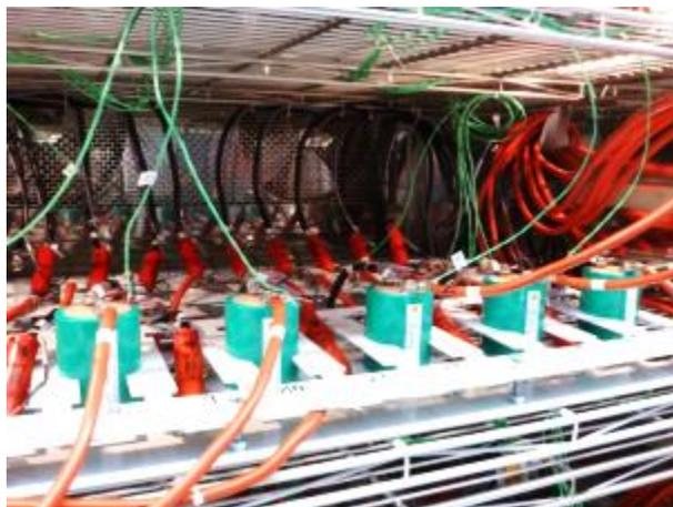
Abbildung 45: Zyklen und elektrische Test im Prüffeld (Sicherheitsprüfschrank)
