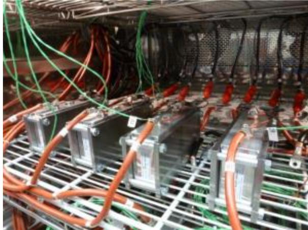
Abbildung 97: 60 Ah-Zellen im Lade- und Entladetest in Sicherheits-Thermoschränken und mit angeschlossener Zyklenanlage
