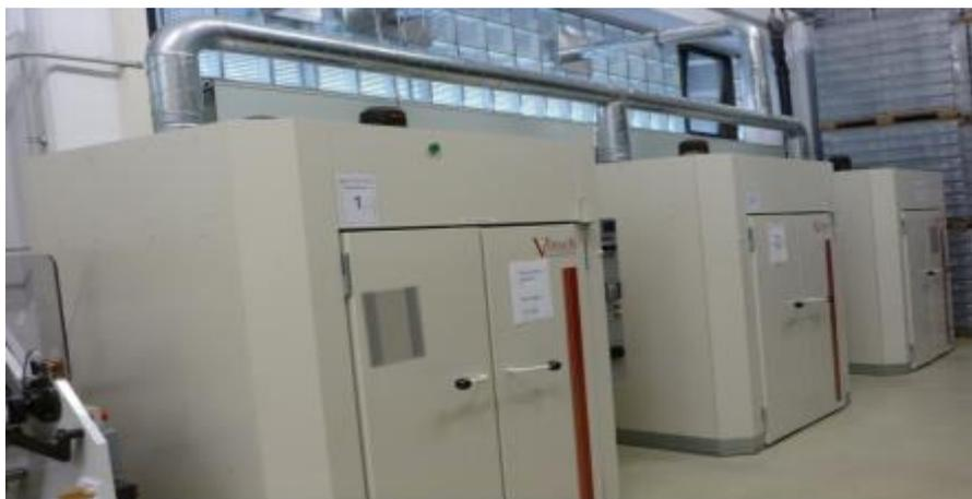
Abbildung 129: Temperprozess in den Öfen
