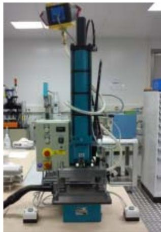
Abbildung 107: Gesamtansicht der pneumatischen Trimm-Vorrichtung für Ableiterbündel.
