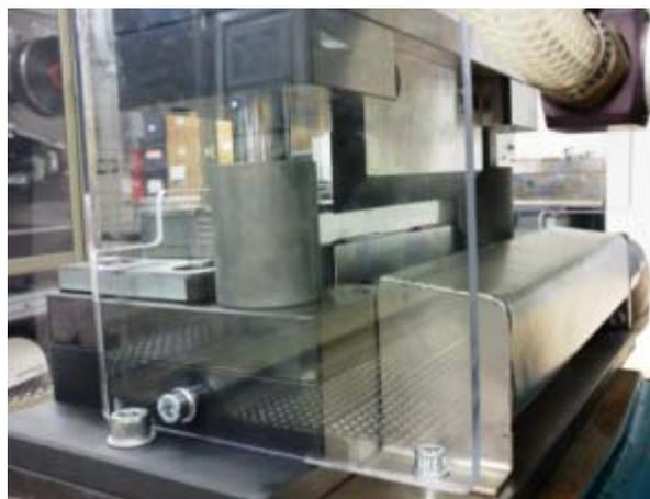
Abbildung 108: Detailaufnahme der Absaugvorrichtung an der pneumatischen Trimm-Vorrichtung
