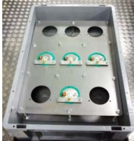
Abbildung 43: Formationskiste mit montierten Rundzellen
