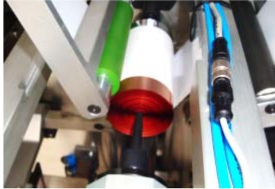
Abbildung 23: Entstehung eines 30-Ah-Rundwickels auf Aluminiumdorn
