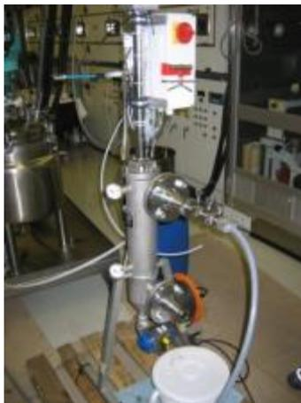
Abbildung 22: Versuchsaufbau zur Pastenfiltration
