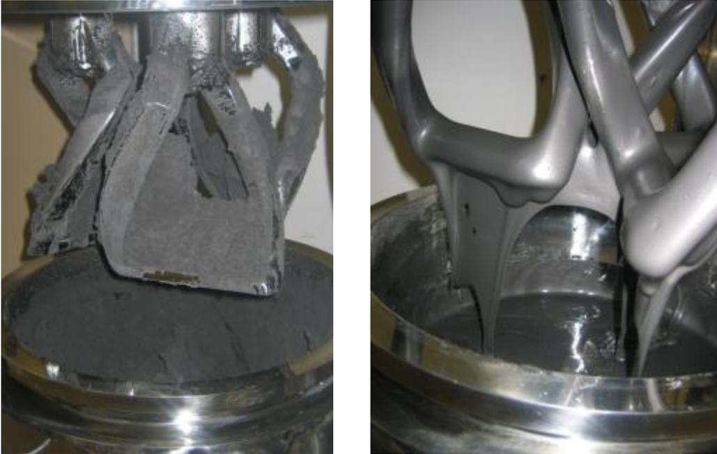
Abbildung 123: Mischprozess mit unterschiedlichen Mischphasen
