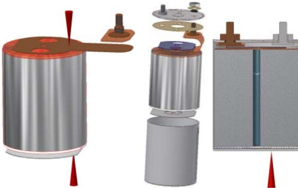
Abbildung 59: Zellkonstruktion mit aufgeschweißten Multikontaktscheiben
