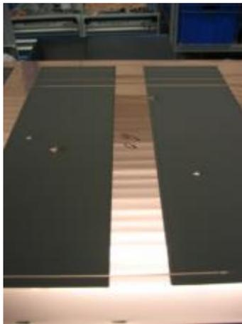
Abbildung 6: Streifenbildung im Beschichtungsbild aufgrund von Agglomeraten in der Anodenpaste
