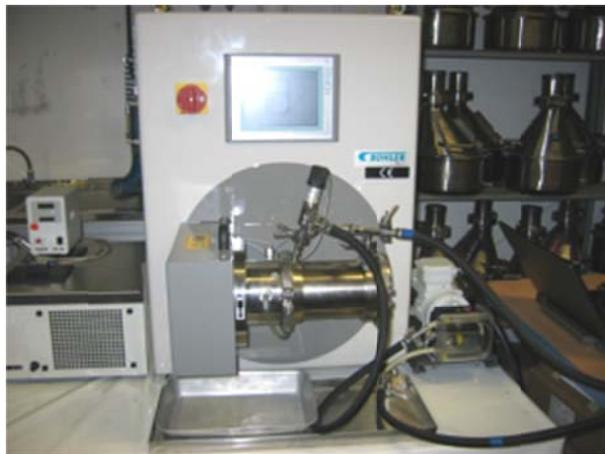
Abbildung 21: Rührwerkskugelmühle mit Datenaufzeichnung, Anschlussleitungen vom Vorlagebehälter, Umwälzpumpe und Kühlsystem
