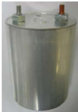
Abbildung 57: 30-Ah Lithium-Ion Rundzelle
