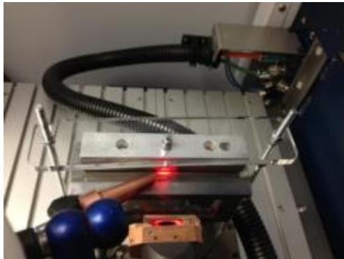
Abbildung 73: Zelle mittels Laserschweißung verschließen
