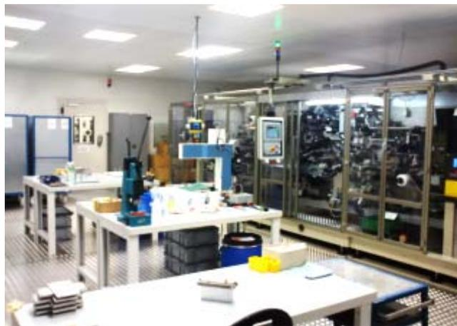
Abbildung 89: Teilansicht des Musterbaus mit Handmontagplätzen für 30-40 und 60 Ah-Zellen
