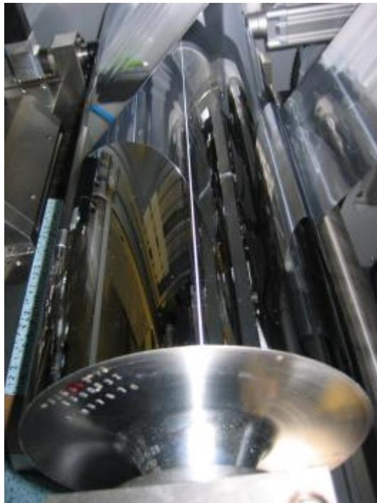
Abbildung 124: Beschichter mit dem Herzstück, der präzisen Beschichtungswalze
