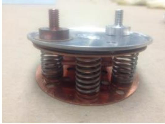
Abbildung 64: Vormontierte Kontaktierungseinheit für Plus- und Minuspol
