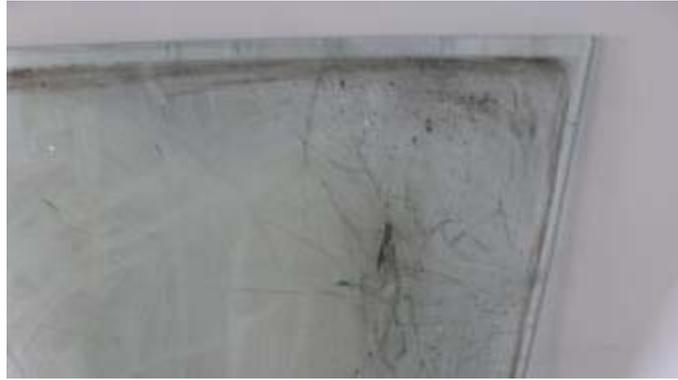
Abbildung 100: Sicherheitsglasscheibe nach dem Nageltest der 60 Ah Zelle
