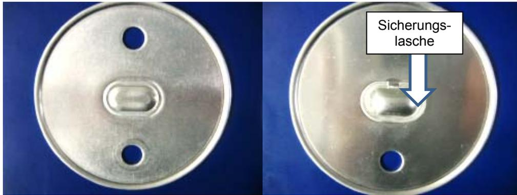
Abbildung 58: Deckeldesign bis Mitte 2011 (links) und überarbeitetes Deckeldesign mit präziserem Öffnungsdruck und Sicherheitslasche (rechts)
