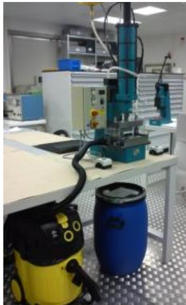
Abbildung 52: Schnittwerkzeug eingebaut in pneumatischer Presse mit Absaugung im Trockenraum
