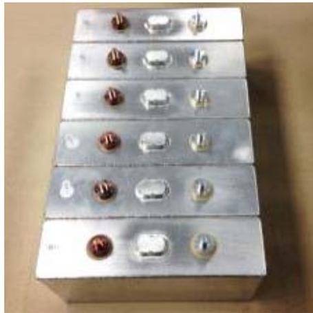
Abbildung 103: Hergestellte 60 Ah-Forschungsversuchszellen zur Abnahme und Freigabe der modifizierten Forschungsversuchsanlagen
