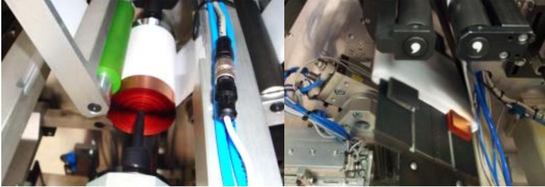
Abbildung 37: Vergleich Wickelstation für runde (links) und prismatische Wickel (rechts)
