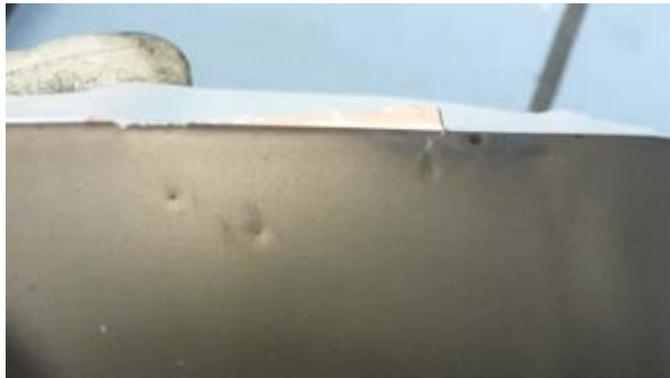
Abbildung 110: Abdrücke von Schweißperlen auf der Elektrodenoberfläche
