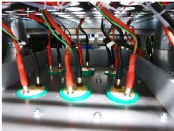
Abbildung 44: Elektrische Kontaktierung während der Formation der Rundzelle
