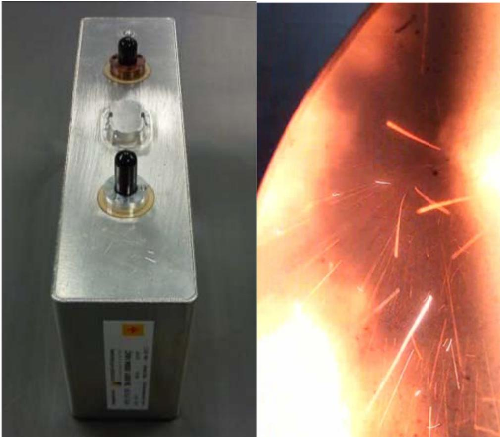
Abbildung 105: Beispiel einer 60 Ah-Forschungsversuchszelle im fertigen Zustand (links) und Auswirkungen des Nageltest einer 60 Ah-Forschungsversuchszelle (rechts).
