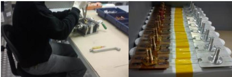
Abbildung 46: Ablängen der Ableiter im Musterbau
