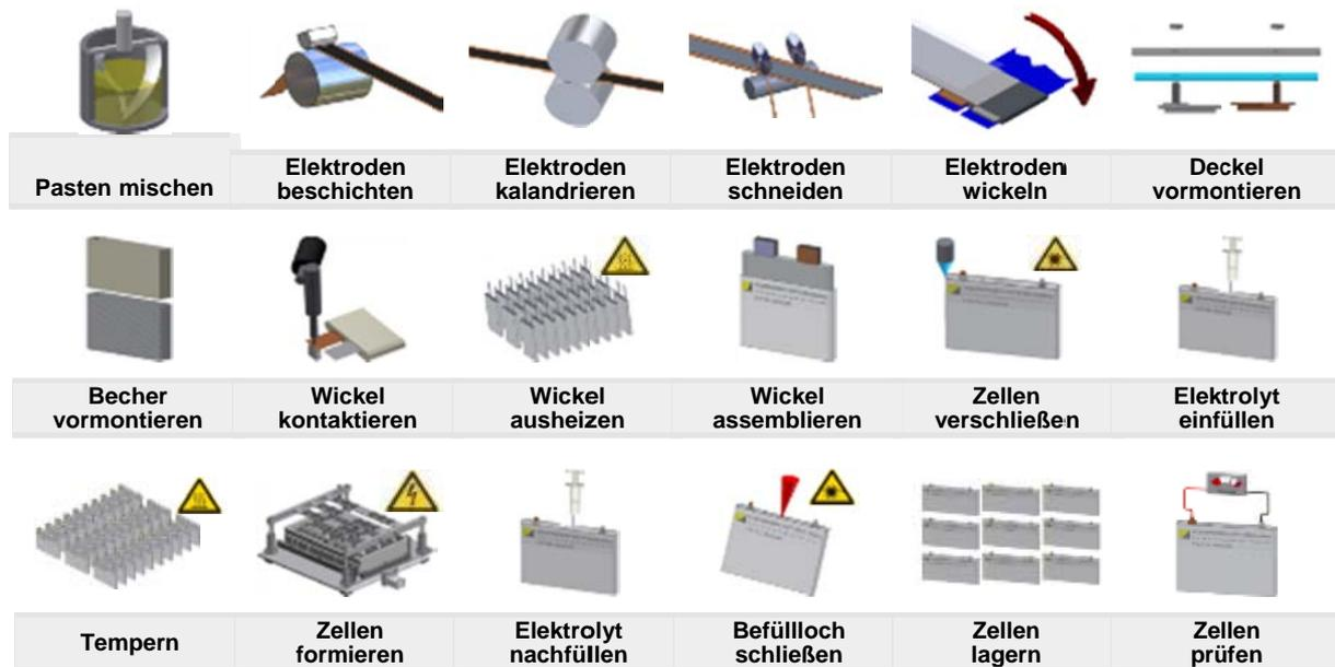
Abbildung 1: Prozesskette zur Herstellung automobiltauglicher Li-Ionen-Batteriezellen
