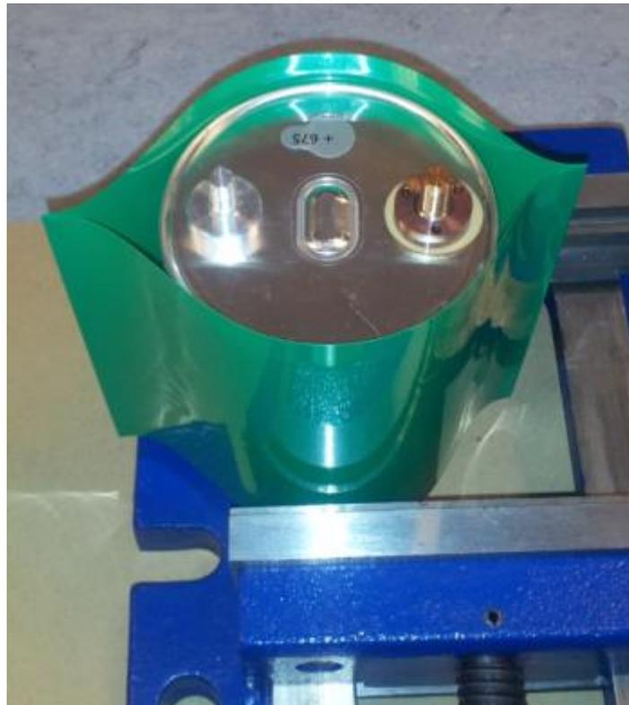
Abbildung 42: 30-40-Ah Rundzelle mit Schrumpfschlauch für die elektrische Außenisolation
