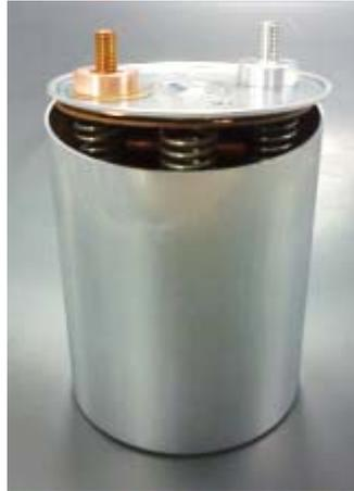
Abbildung 41: Trocken montierte Zelle vor Laserschweißung von Deckel mit Becher
