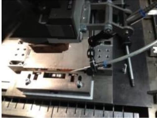
Abbildung 72: Modifizierte Schweißvorrichtung für Laserschweißen von Wickel mit Deckel
