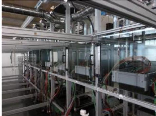
Abbildung 91: Formationsanlage mit Sicherheitskabinen
