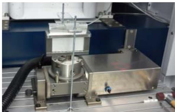
Abbildung 79: Ansicht des Bearbeitungszentrums des Lasers mit Vorrichtung zum Verschweißen von Deckel und Gehäuse
