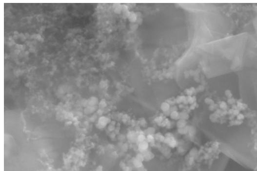
Abbildung 5: REM-Aufnahme einer fertigen Si/C-Komposit Anode in 20.000-facher Vergrößerung. Sichtbar sind Silizium- und Rußpartikel auf mehreren Graphitplättchen.
