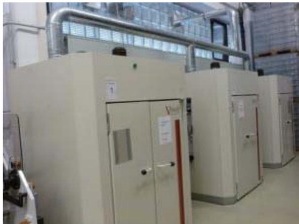
Abbildung 101: Temperierschränke mit Lösungsmittelsensoren und Abluftanlage
