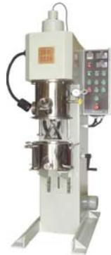
Abbildung 15: Beispiel eines lastenheftkonformen Doppelplanetenmischers
