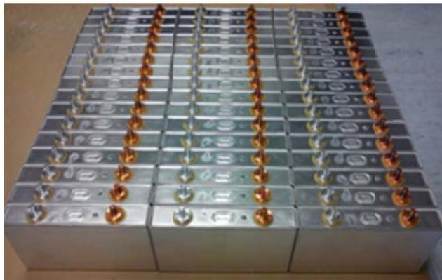
Abbildung 71: Forschungsversuchszellen noch ohne Außenisolation
