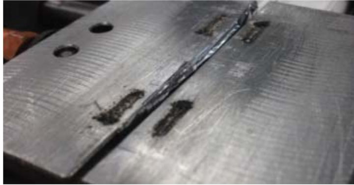
Abbildung 106: Versatz der Einzelschnitthöhen bei Verwendung der Zange.
