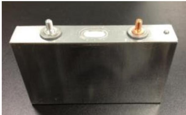
Abbildung 74: Fertige Zelle ohne Käfig über der Berstmembran
