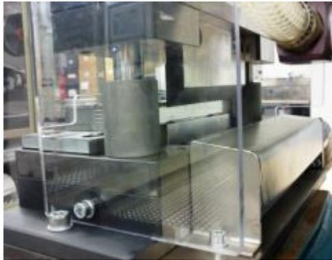
Abbildung 51: Ausschnitt aus dem Schnittwerkzeug mit Messersatz, Absaugung und Schutzeinhausung
