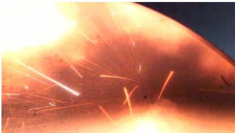
Abbildung 99: Nageltest einer 60-Ah-Zelle mit starker Rauch und Feuerentwicklung
