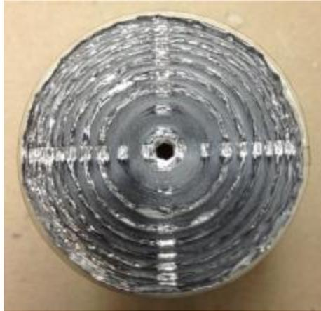
Abbildung 39: Abdruck vom Kontaktblech auf Plusseite des Wickels.
