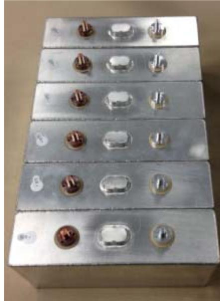
Abbildung 93: Lasergeschweißte Deckel mit Becher vor der Elektrolytbefüllung
