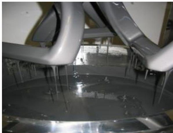
Abbildung 81: Fertige Paste am Mischwerkzeug mit glatter Erscheinung und idealem Abtropfverhalten als Zeichen optimal eingestellter Viskosität
