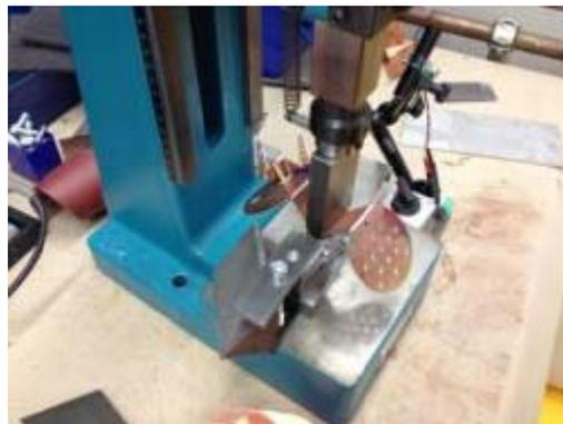
Abbildung 63: Werkzeug zur Herstellung der Multikontaktscheibe (Sigma-Blech)
