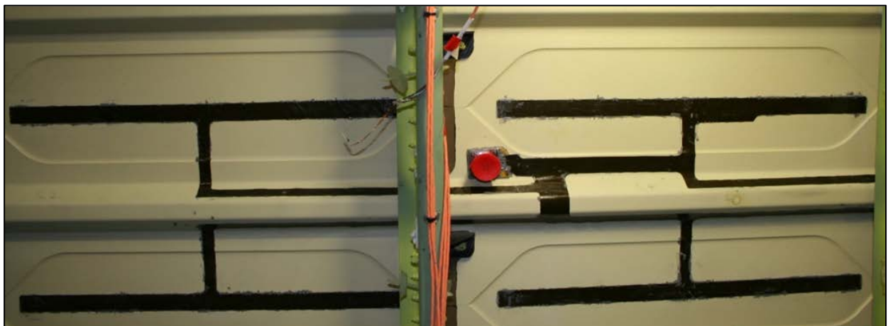
Abbildung 11: Installierte Sensorik im Inneren des Flugzeuges
