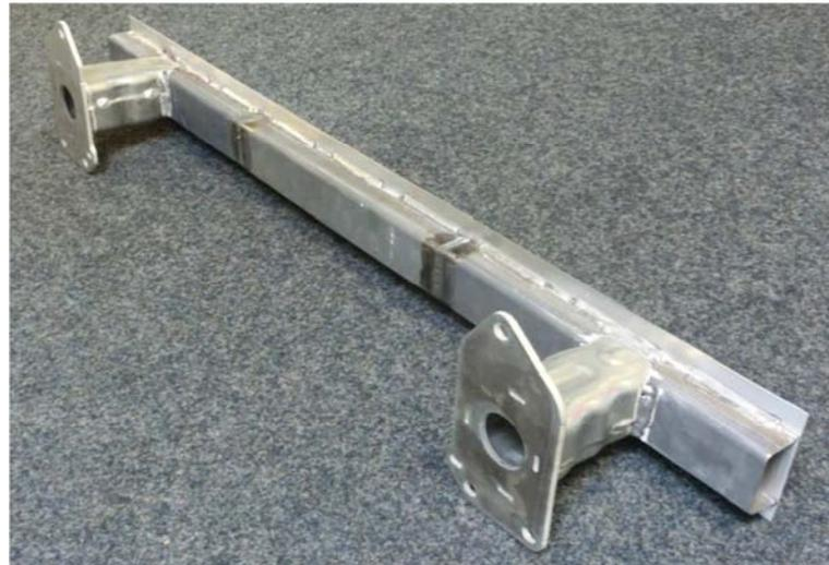
Bild 40: Demonstrator Borstahl mit Aluminium
