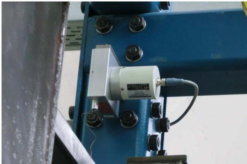
Abbildung 35: Fadenpotentiometer
