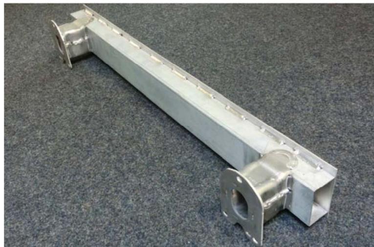
Bild 39: Versuchsteil verzinkter Stahl mit Aluminium / Magnesium
