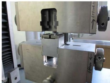
Abb 18: Zugversuchsadaption für Kehlnähte
