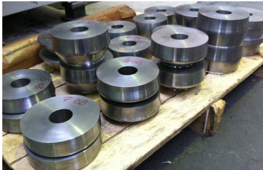
Abb. 07: gedrehter Rollensatz
