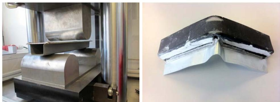
Abb 19: 3-Punkt-Biegeversuch - statisch
