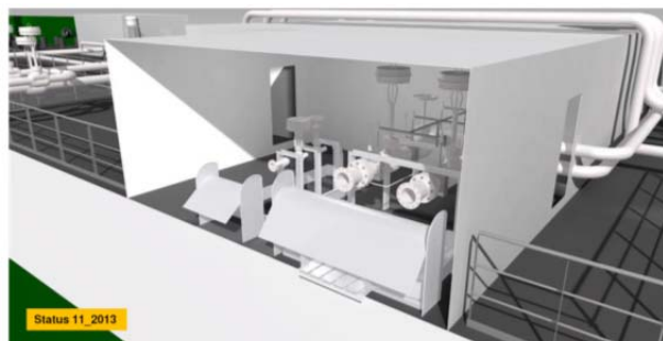
Abb. II.3: Bunkerstation des Bunkerschiffes
