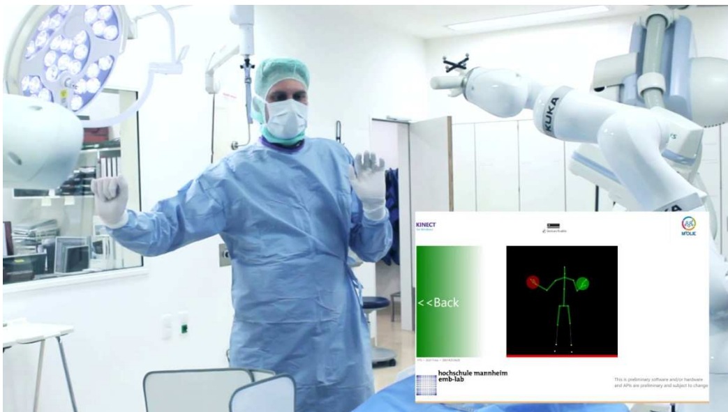
Abbildung 10 - Anwendung des Prototyps der Gestensteuerungs-App
