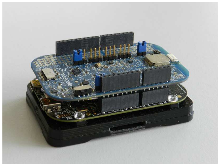
Abbildung 15 - Konfiguration des drahtlosen inertialen Sensorsystems zur Erfassung der Dynamikbereiche von Objekten und Personen im OP
