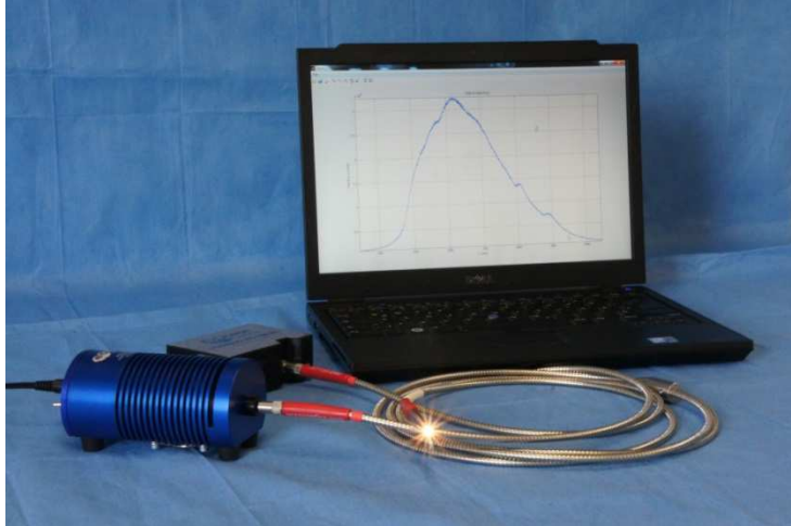
Abbildung 3 - Optisches Spektrometersystem mit Lichtquelle zur Durchführung der Vorversuche zur Inline-Sensorik
