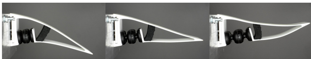
Abbildung 57: Neues Hinterkantenkonzept mit thermoplastischer Struktur und Balgaktuator
