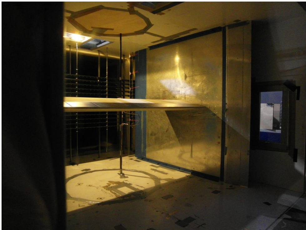
Abbildung 53: Flügelmodell der flexiblen Hinterkante im Windkanal mit Jalousieblende
