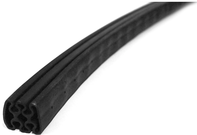
Abbildung 66: Extrudierter Balgaktuator aus TPE
