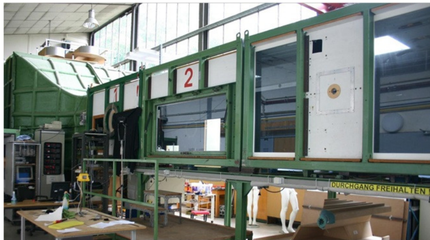
Abbildung 34: Der große Windkanal am HFI
