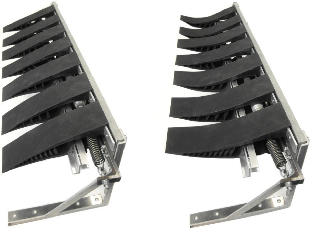
Abbildung 25: Prototypen-Versuchsstand - Variationen der flexiblen Hinterkantenstruktur und Auslenkung nach unten sowie oben
