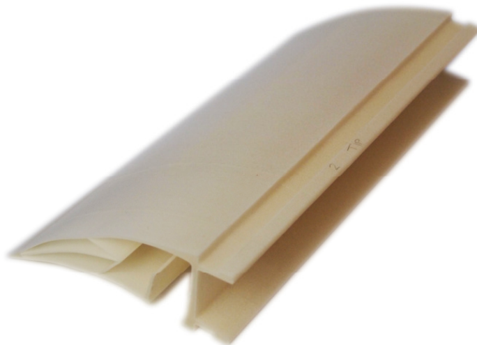
Abbildung 64: Mittels SLS-Verfahren hergestelltes Hinterkantenelement
