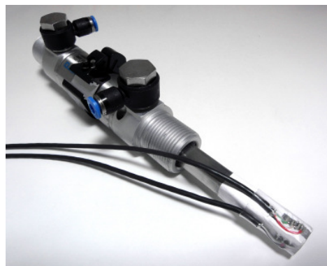
Abbildung 36: Messzylinder zur Ermittlung von Zylinderposition und Aktuierungskräften
