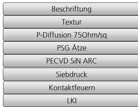
Abbildung 34: Prozessfluss zur Herstellung kristalliner Siliciumsolarzellen mit Al-BSF.
