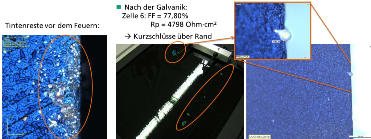
Abbildung 24: Links: Tintenreste vor dem Feuern und rechts: galvanisch abgeschiedenes Silber, welches den Parallelwiderstand herabsetzt.
