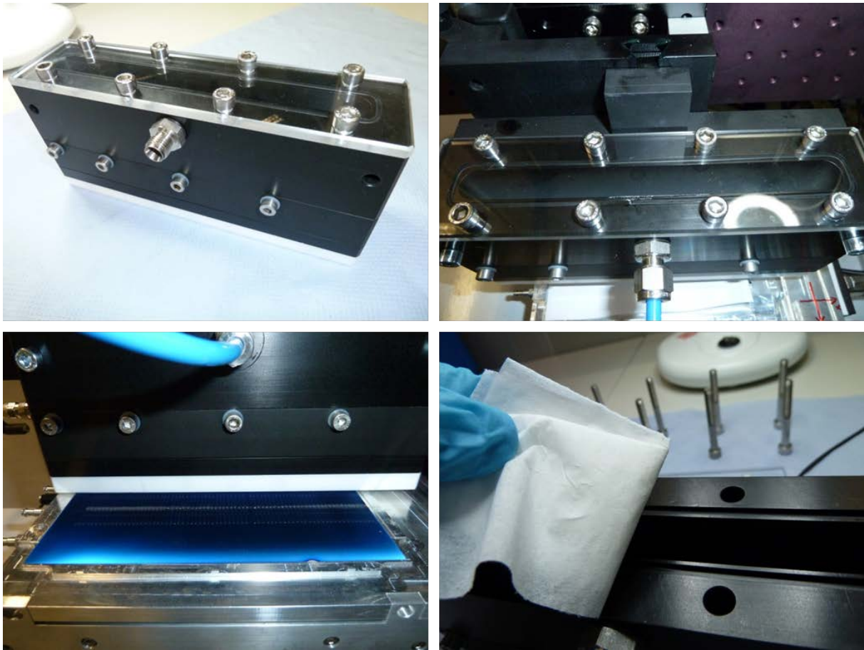
Abbildung 7: Am Fhl ISE gefertigten Aerosoldruckkopf; (i) perspektivisch, (ii) & (iii) in Aktion an einem Teststand des ISE, (iv) Prüfung, ob sich Aerosol im Druckkopf abgeschieden hatte (v.o.l.n.r.u.).
