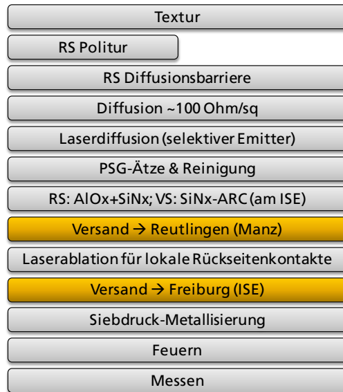
Abbildung 68: Solarzellen-Herstellungsprozessablauf der Charge 130218. Alle Prozessschritte wurden am Fraunhofer ISE durchgeführt mit Ausnahme des Laserablationsprozesses, der bei der Manz AG in Reutlingen durchgeführt wurde und bei dem der Abstand (Pitch) der Ablationslinien variiert wurde. Es kam hierbei der ISE-Referenz-Beschichtungsprozess zum Einsatz.
