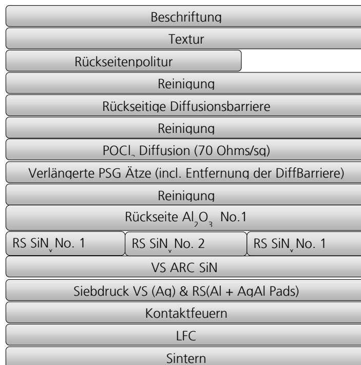
Abbildung 46: Prozessfluss zur Herstellung kristalliner PERC-Siliciumsolarzellen.
