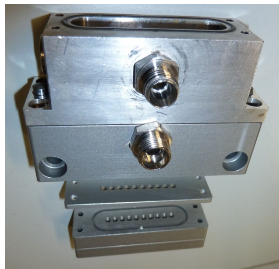
Abbildung 10: Neu gebaute Komponenten zur Aerosolfokussierung, v.o.n.u.: Aerosolkammer, neue Fokussiergaskammer, Abstandsplättchen, optimierte Düsenplatte mit Düsenschutz.
