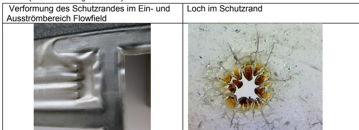
Abbildung 25 Leistungsmängel, Alterungsmechanismen MEA- Schutzrand
