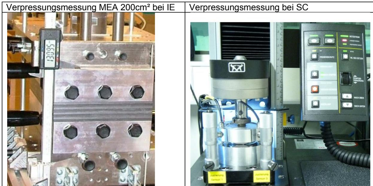
Abbildung 32 Messeinrichtungen für Kraft-Weg Kurven
