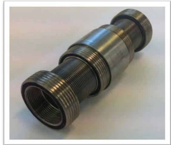
**Abbildung 13:** Fertige Ringsegmente (links) und rohrartiger TEG-Demonstrator (rechts)
