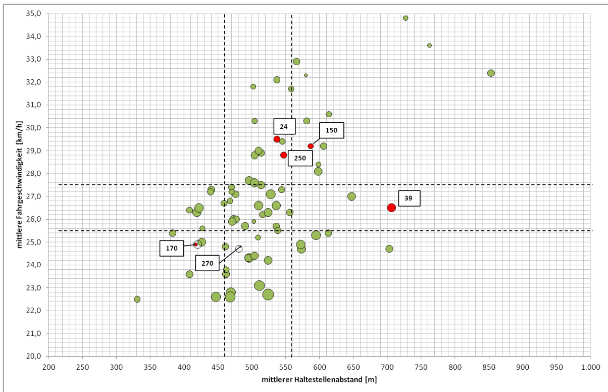
Abbildung 6: Clustering der Solobus-Linien nach mittlerer Fahrgeschwindigkeit, mittlerem Haltestellenabstand und Anzahl Halte auf der Strecke (Größe der Bubbles)
