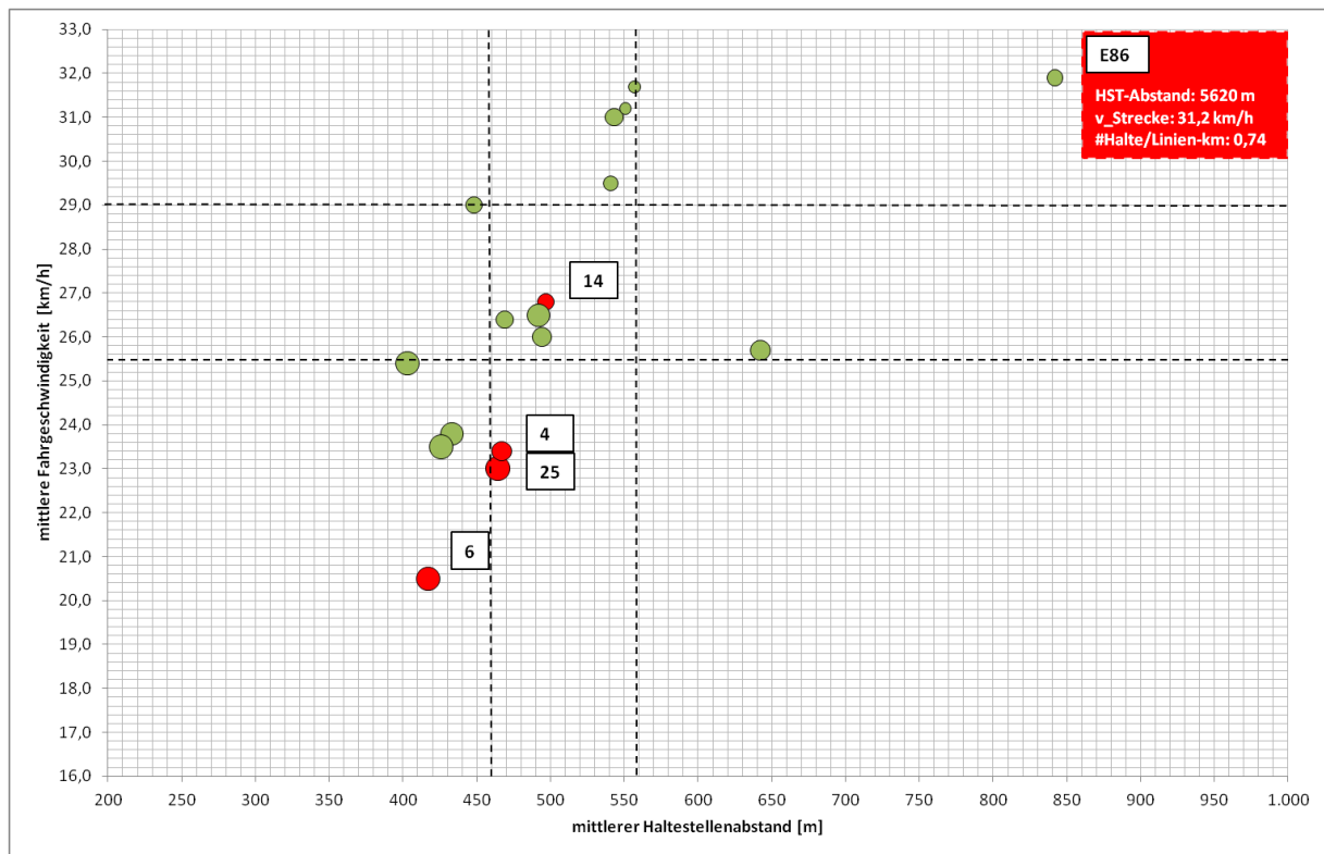
Abbildung 4: Clusterung der Gelenkbus-Linien nach mittlerer Fahrgeschwindigkeit, mittlerem Haltestellenabstand und Anzahl Halte auf der Strecke (Größe der Bubbles)
