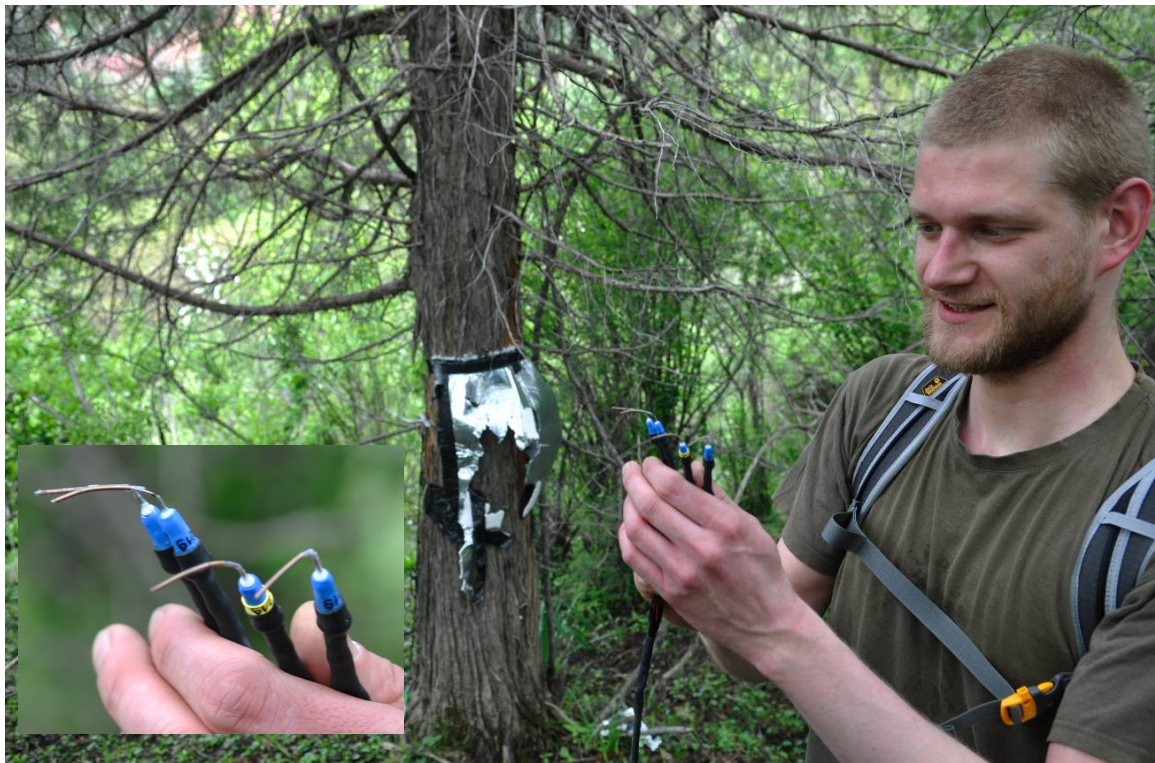
Abb. 3.2: Zerstörte Xylemsaftfluss-Sensoren am Monitoring-Standort SaryChelek.
