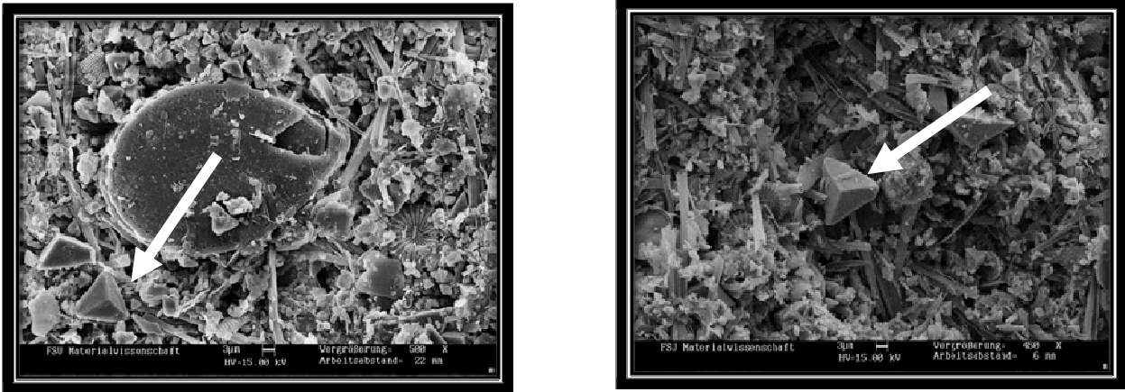
Abb. 2.6: Sedimentfallenmaterial mit idiomorphen Monohydrocalcit-Kristallen (Pfeile) in einem Gemisch von Diatomeen und Mineralen. Daraus ist ersichtlich, dass der Monohydrocalcit in der Wassersäule gebildet wurde.
