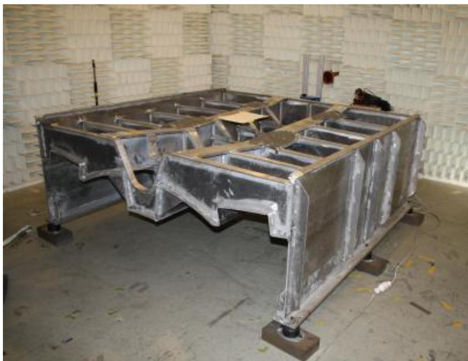
Abbildung 2.5: AAL-Schiffsfundament im halbschalltoten Raum des Fachgebiets SzM
