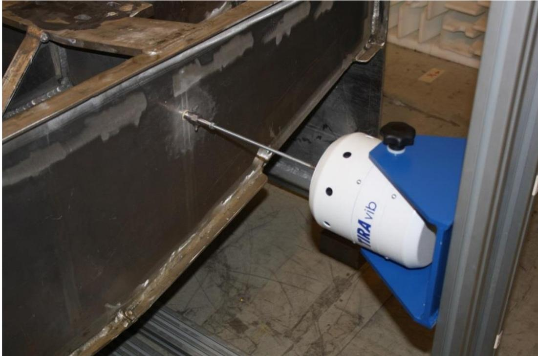
Abbildung 2.16: Anregung des Fundaments mit einem elektrodynamischen Shaker
