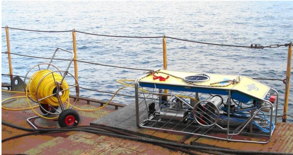
Abbildung 6: Remotely Operated Vehicle (ROV) mit Steuerungskabel an Deck des Forschungsschiffs.
