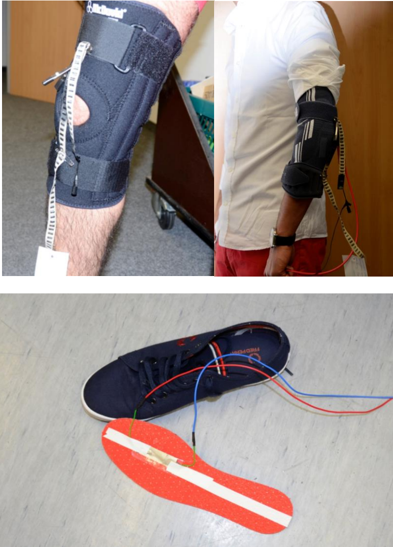
Abbildung 22: Charakterisierung der Piezofasern an einer Arm-, einer Beinbandage und einer Einlegesohle
