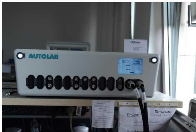
Abbildung 3: Impedanzspektrometer zu Ermittlung des Wechselstromwiderstands der Piezofasern
