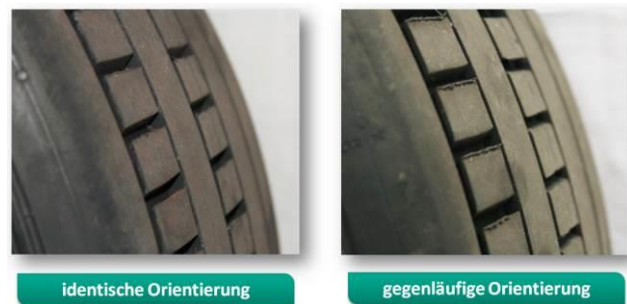
Abbildung 12: Versuchsreifen R4b & R4c: geneigte Rillen auf mittlerer und äußerer Profilspur
