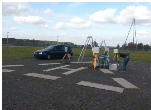
Abbildung 15: Messaufbau: 2 Antennen in einer Höhe ca. 1 m und eine Antenne in einer Höhe von ca. 2m
