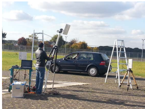
Abbildung 14: Messaufbau: 4 Antennen in gleicher Höhe (ca. 1m)
