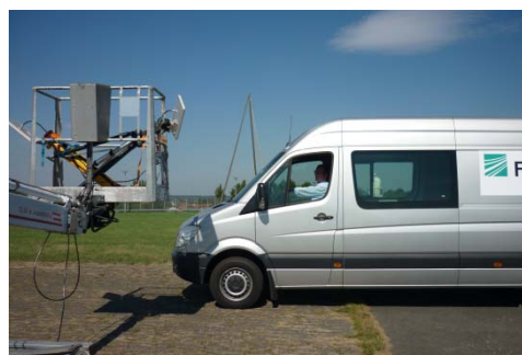
Abbildung 17: Zwei RFID-Antennen an Hebebühne befestigt (Höhe ca. 2,5 m)
