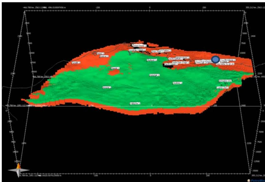
Abbildung 29: Rezente Ausdehnung Gashydratstabilitätszone im Arbeitsgebiet. Der blaue Kreis zeigt die Lage der Mount Elbert Testbohrung.
