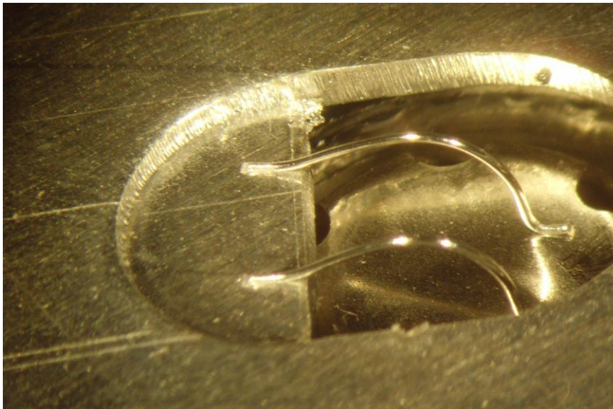
Abb. 29: Mit Dickdrahtbonds gebondeter Deckel einer 18650 Zelle
