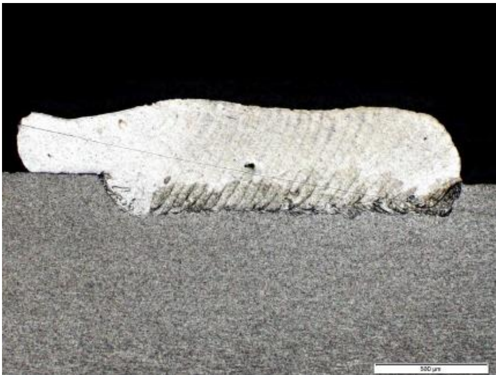
Abb. 38: Schliffebene 1 an Versuch 8 (Pluspol) Mikraufnahme 80%
