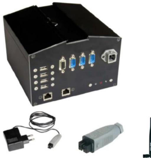
Abbildung 3-16: Systemkomponenten SIGNOS Set-Top-Box
