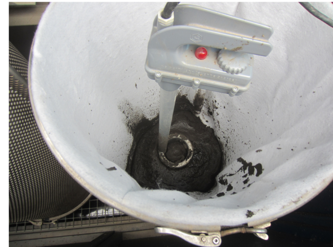
Bild 12b Foto der elektr. Heizsonde im Filterrack
