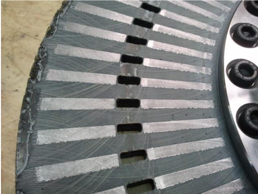
Abbildung 14: Zwischen den Zähnen geschlitze Rotorscheibe (Ausschnitt)
