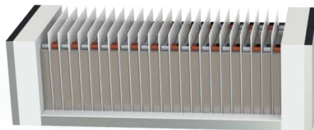
Abbildung 26: Batterie-Stack bestehend aus 24 prismatischen 5 Ah Hochleistungs-Li-Ionen Zellen.
