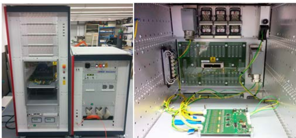
Abbildung 32: HiL-Prüfstand (links) und Versuchsaufbau mit Zellcontrollerplatine (rechts).
