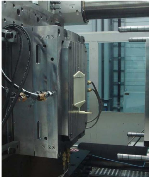
Abbildung 18: Spritzgießwerkzeug zur Herstellung von langfaserverstärkten Platten mit gerichteter Faserorientierung
