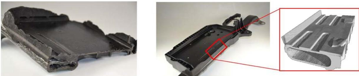
Abbildung 37: Kollabiertes Hohlprofil (links), schadungsfrei umspritztes Hohlprofil (rechts)
