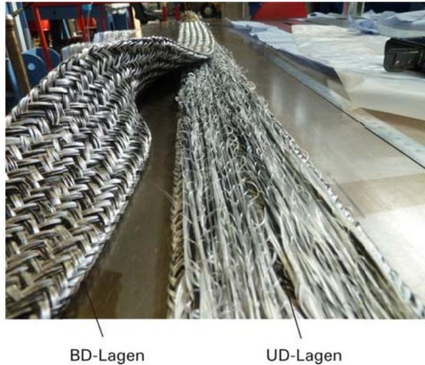
Abbildung 22: Triaxialer FKV-Aufbau; Festlegung der Fertigungstechnologie
