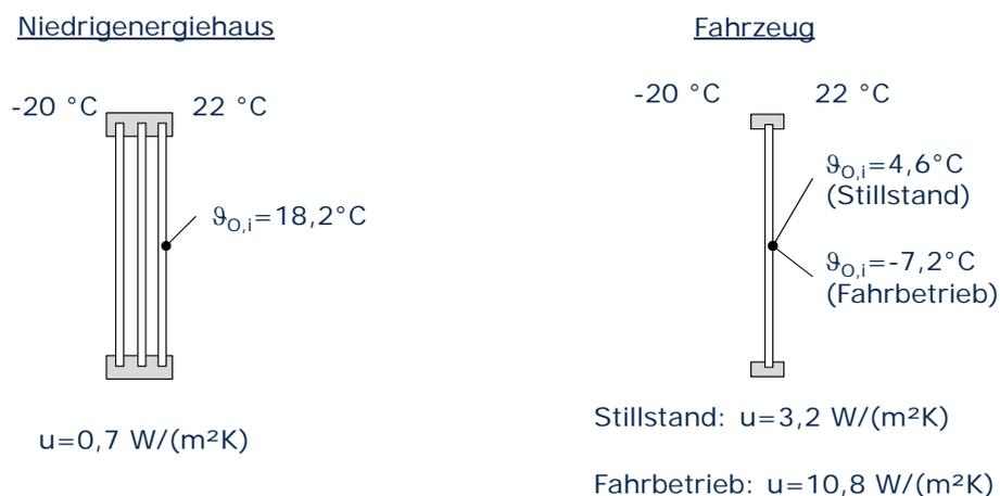
Abbildung 2: Vergleich typischer Kennwerte von Verglasungen von Gebäude und Fahrzeug
