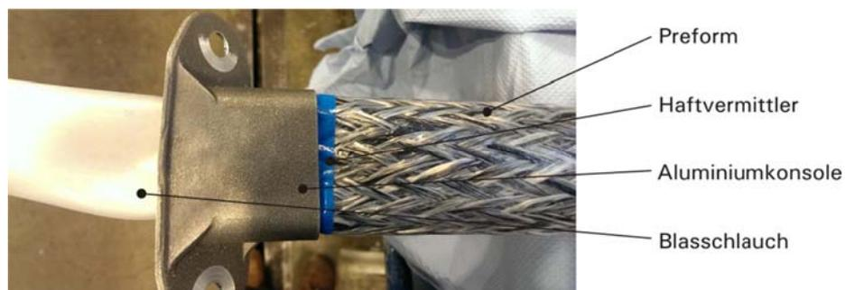
Abbildung 33: Vorbereitete Preform mit Haftvermittler, Aluminiumkonsole, Blasschlauch
