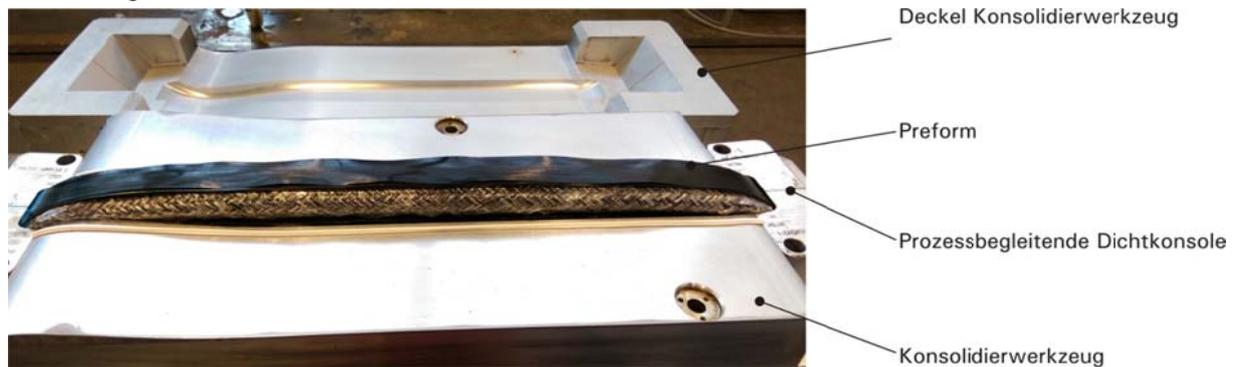
Abbildung 34: Preform in Konsolidierwerkzeug
