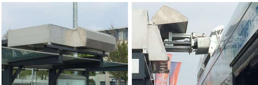
Bild 23: Schnellladesystem der RWTH Aachen in Münster
