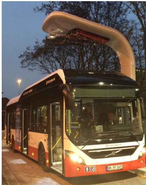
Bild 22: Schnellladesystem von SIEMENS in Hamburg
