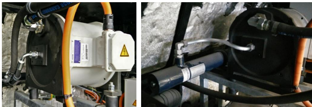
Bild 5: Lenkhydraulikpumpe ohne Silencer (links) und nach Integration des Bauteils (blau)
