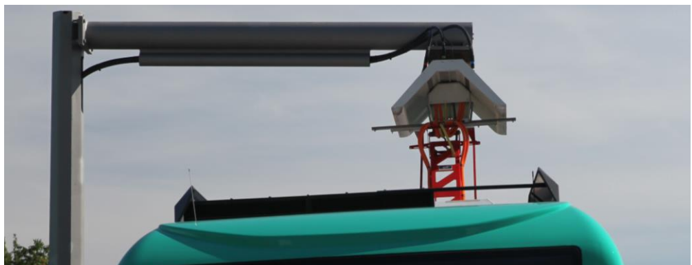
Bild 10: Hochstromkontakt- system im geschlos- senen Zustand bei einseitig abgesenk- tem Fahrzeug (Knee- ling)
