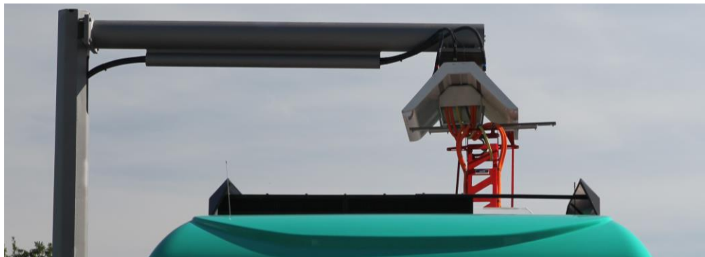
Bild 9: Hochstromkontakt- system im geschlos- senen Zustand bei Fahrzeug in Normal- lage
