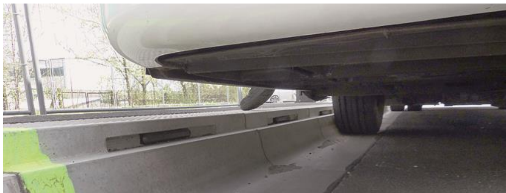
Bild 11: RFID-Technologie im Bordstein für die Positionserkennung des Fahrzeuges
