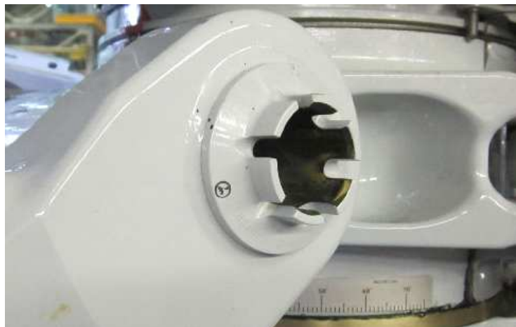
Bild 4: Modifizierter „torsion link bolt“ mit „castellated edge“-Öffnung am Bugfahrwerk der Boeing 747-8I.
