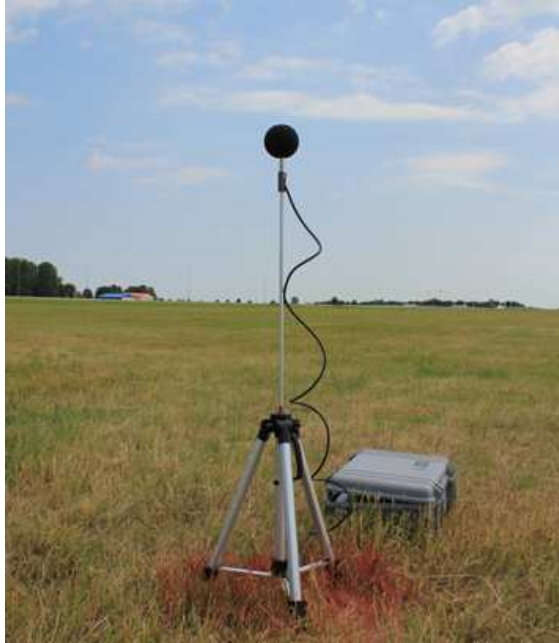
Bild 13: Eine Messstelle mit Mikrophon auf rund 1,2 m Höhe und Koffer mit Geräten zur Datenaufnahme und -übertragung.
