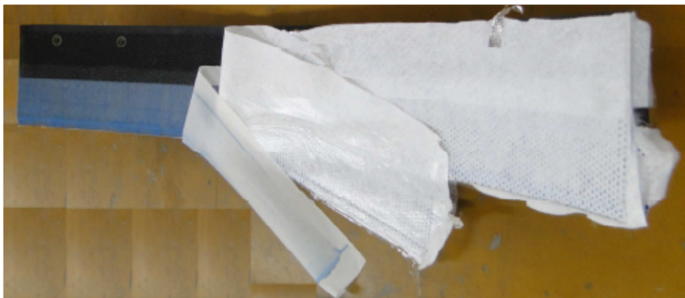
Bild 6: Modifiziertes Acoustic Panel mit Abreißgewebe und Vliesstoff nach dem Aushärten.
