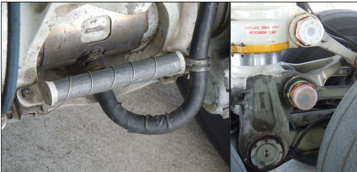
Bild 15: MD11-Hauptfahrwerke: Drahtumwicklung an einer Strebe; rechts: Kunststoffabdeckungen über Hohlräumen.
