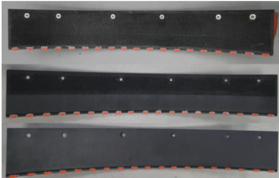
Bild 7: Panels im Vergleich: Baseline (oben), partielles Hardwall Panel (Mitte) und Hardwall Panel (unten).
