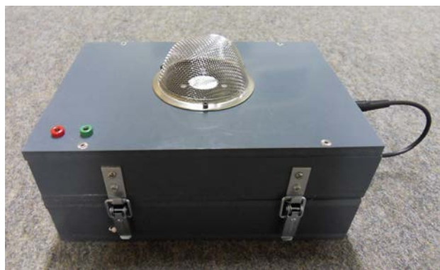
Abbildung 2.8.2: Foto eines UBPM. Erkennbar sind das halbkugelförmige Drahtgitter zur Begrenzung des elektrischen Feldes und die mit Aluminiumfolien bedeckte Anode am Mittelpunkt des Drahtgitters.
