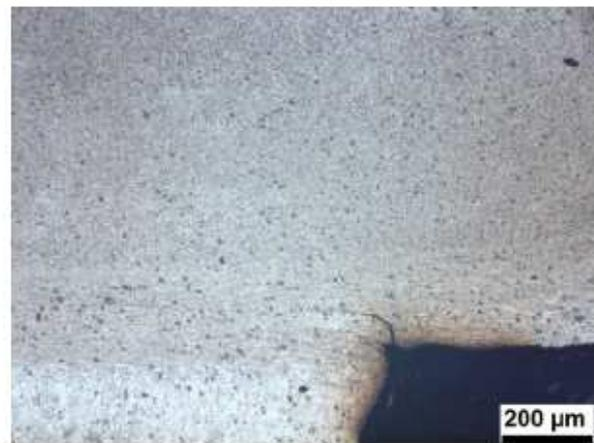
Abbildung 5-37: Mikroschliffe Radienauslauf T-Stoß Naht [Quelle: APWORKS (EADS-IW)]
