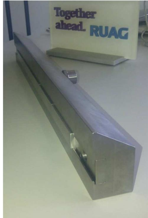
**Abbildung 5-26: 3D Modell und Prototyp Hydraulik-Spannbalken**
