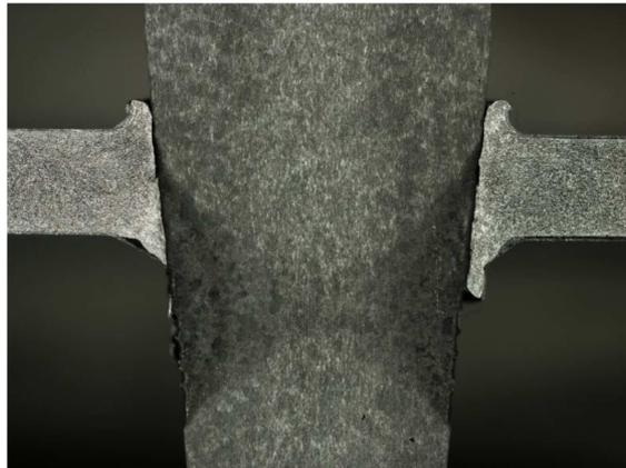
**Abbildung 5-14: Geätzter Makroschliff der Reibschweißverbindung 404 (12000 1/min, 6000 N)**
