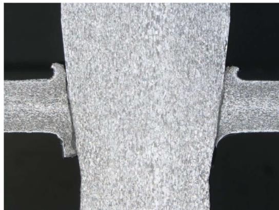
**Abbildung 5-13: Geätzter Makroschliff der Reibschweißverbindung 205 (12000 1/min, 5500 N)**
