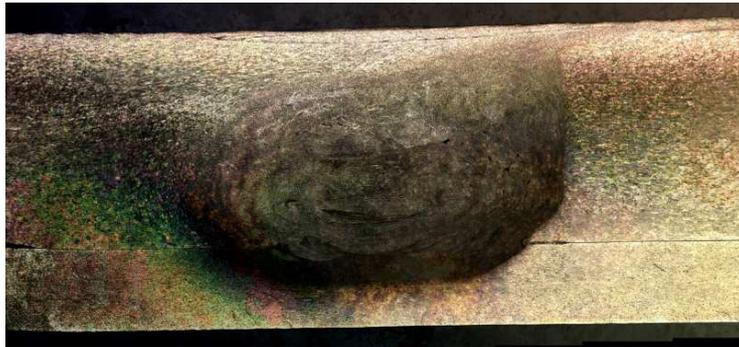
**Abbildung 5-39: Mikroschliff – "Lost Backing"**
