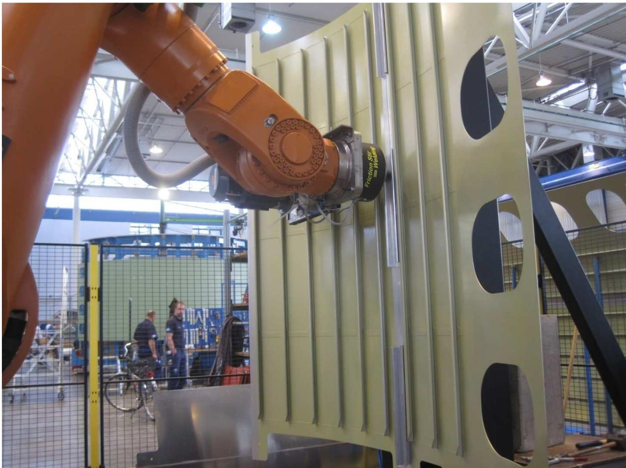
Abbildung 5-55: Schweißung Validator/Demonstrator A330/340 S14a
