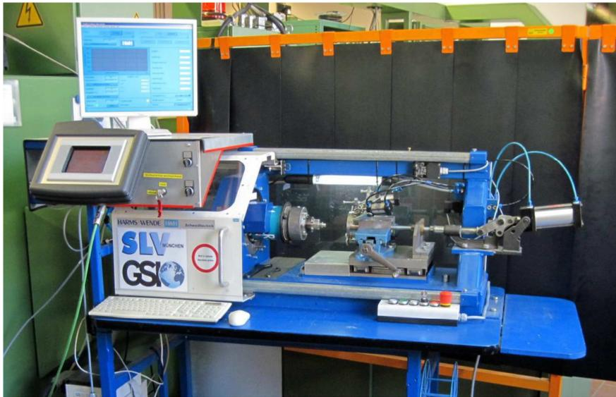
Abbildung 5-8: Reibschweißmaschine H&W RSM 401
