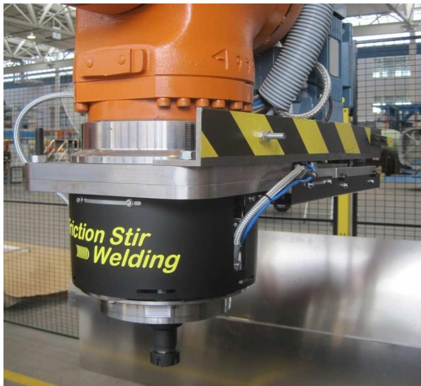
Abbildung 5-49: RUAG FSW Endeffektor Prototyp
