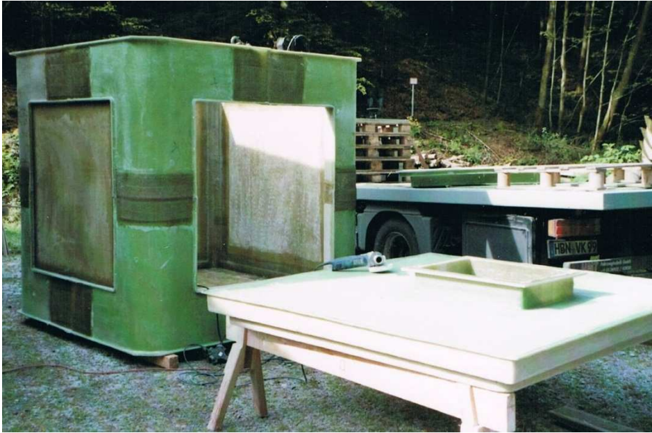
Abb. 3.19 Deckelmodul mit Mannloch - Fertig zum Einbau in Speicher
