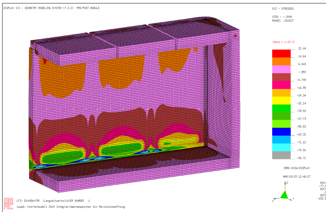
Bild 81 Spannungen \sigma_{yz} [N/mm 2 ] in den PUR-Hartschaum-Kernen. Lastfall 3: EG+HWD+T95.
