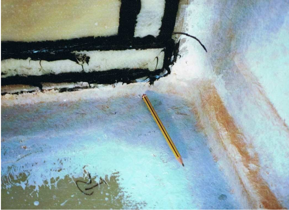
Abb. 4.5 Rißbildung beim Überlaminat durch Nachrutschen von VI in Richtung Falz
