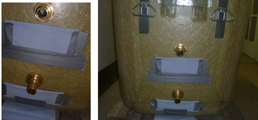
Bild II.24 Durchführung durch fast ebene (leicht gekrümmte) Fläche, dicht
