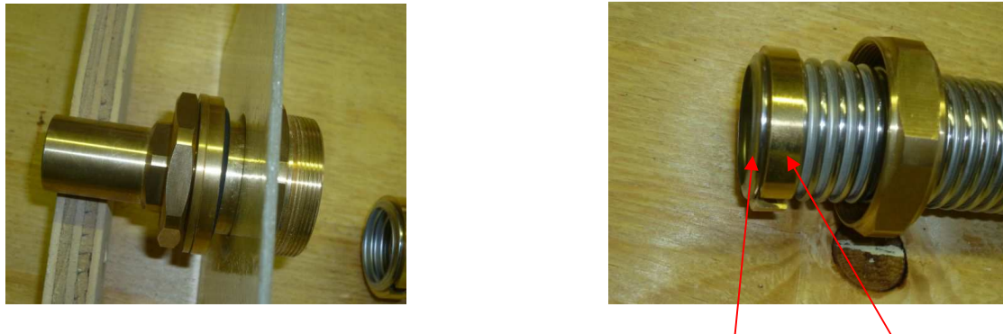
Bild II.23 Wellrohranschluss an Wanddurchführung erste Welle Klemmring
