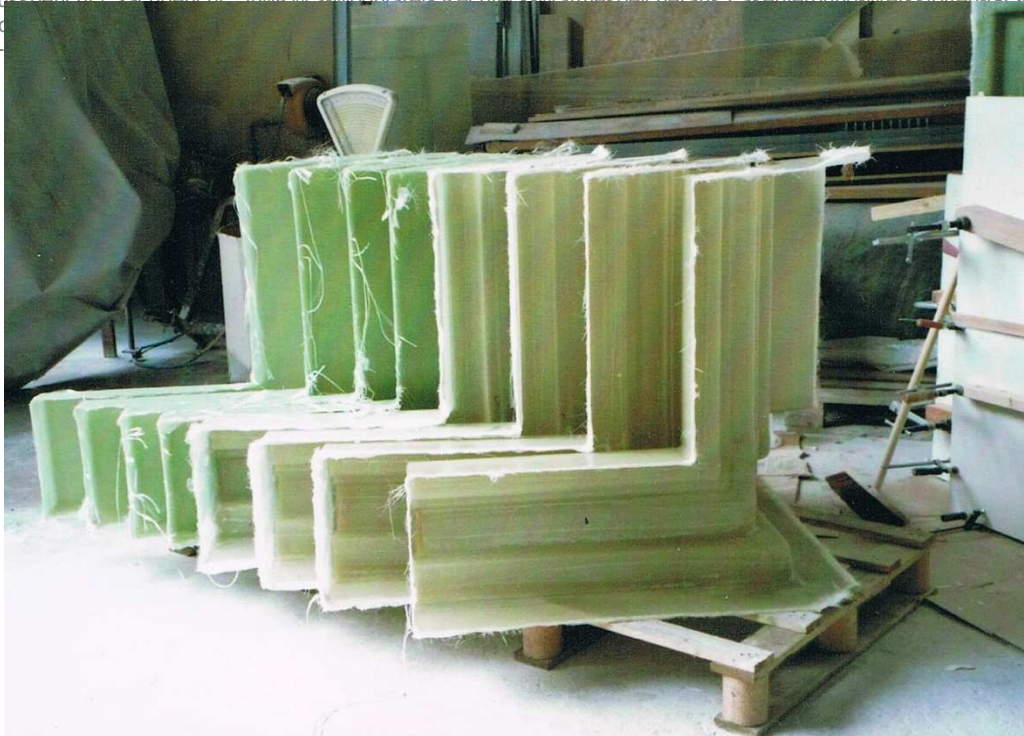
Abb. 3.5 Entformte Innenschalen der „Dreibein- Eck-Elemente
