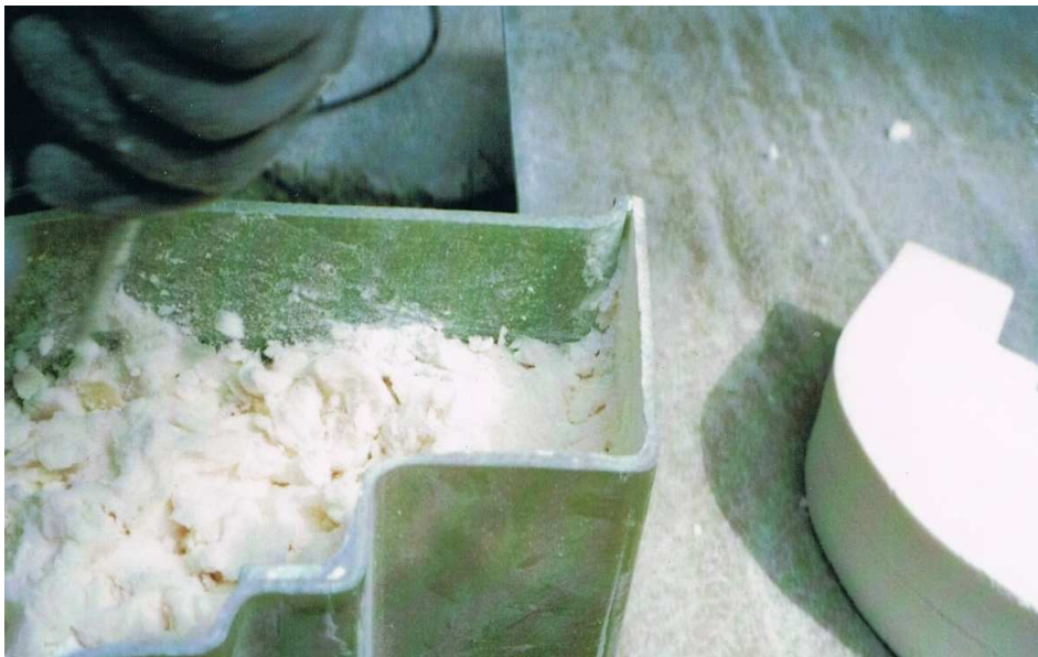
Abb. 3.14 Verbindungsaufbau der Eckmodule mit PUR - Dübeln
