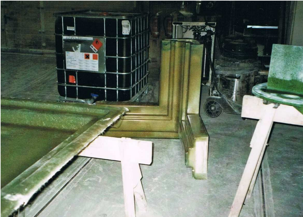
Abb. 3.7 Fertiger Eckmodul vor dem Beschneiden sowie vorgefertigte Außenschale (I) für Seitenwandmodul
