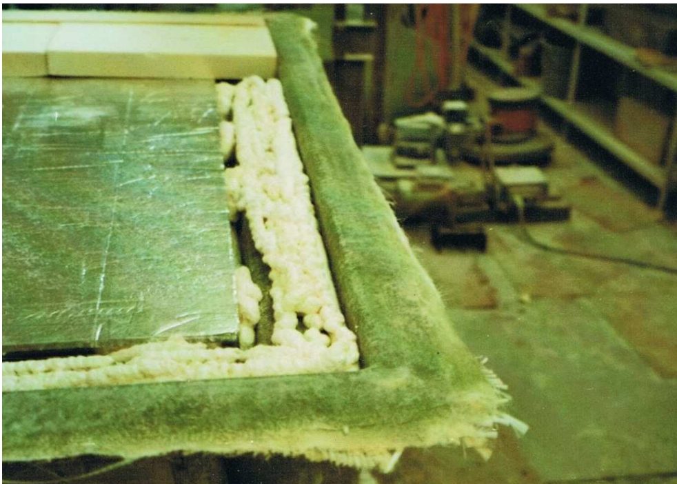
Abb. 3.10 Verschuß der VIP – Elemente zum Rand und zur inneren Deckschicht
