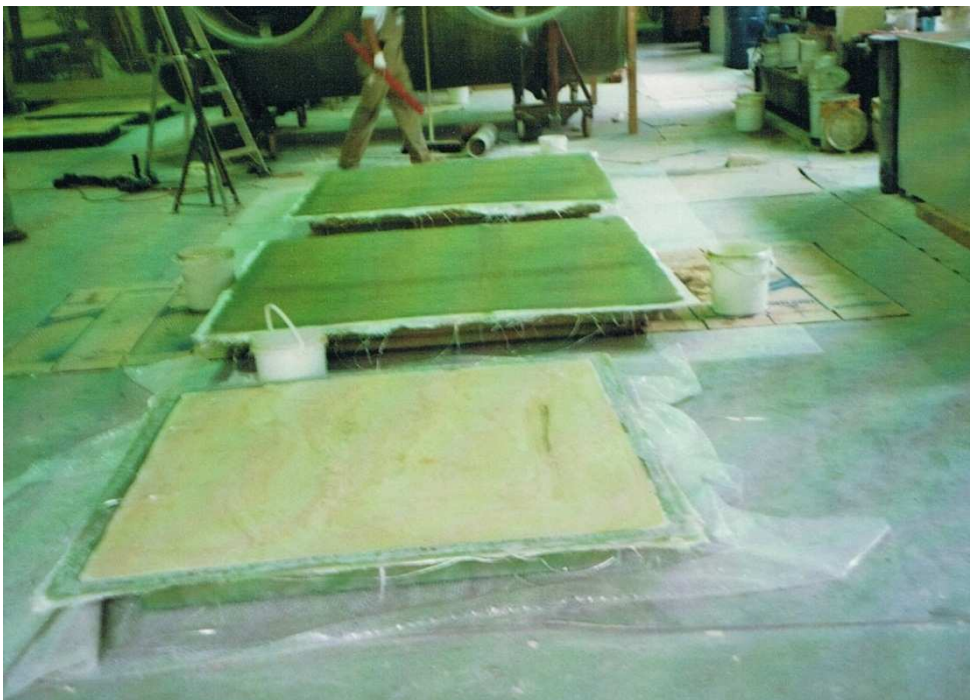
Abb. 3.12 Verschuß der ausgeschäumten Außenschalen mit dem Traglaminat im Naßverfahren
