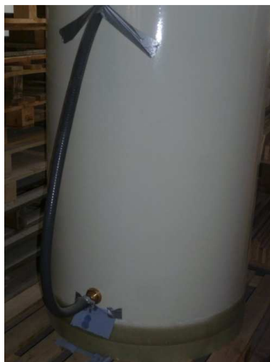
Bild II.22 Durchführung durch stark gekrümmte Wandung ( \varnothing=700 mm), undicht
