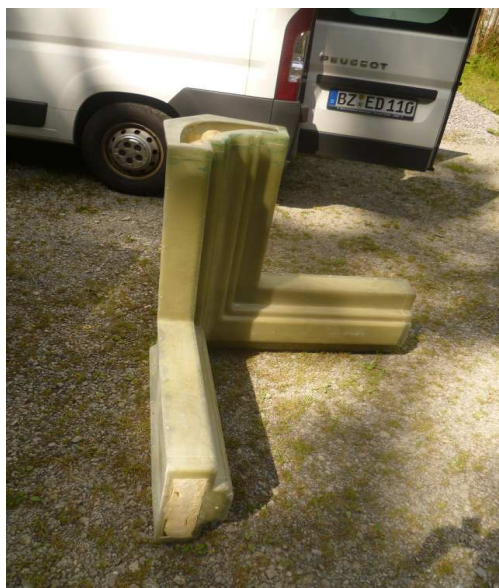
Bild II. 2 Rahmen-/Eckmodul Zustand nach der Rohteilherstellung/ unbearbeitet
