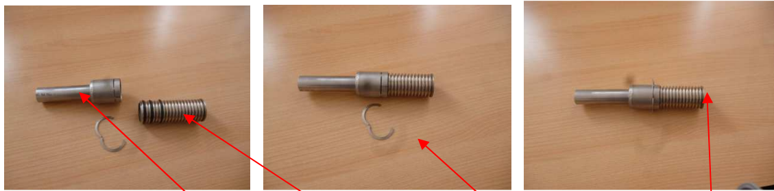
Bild II.28 modifizierter Wellrohranschluss für Doyma-Wanddurchführung, bestehend aus 5 Einzelteilen: Glattröhrhülse, 3 O-Ringe, Sicherungsring; (Wellrohr in Bedarfslänge)
