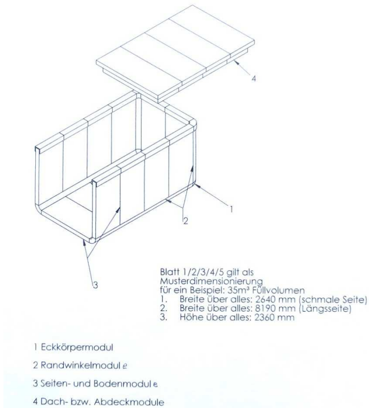
Abbildung III.1.1 Integral - Wärmespeicher- ARGE Modulbauweise (Bodenwanne + Abdeckung)
