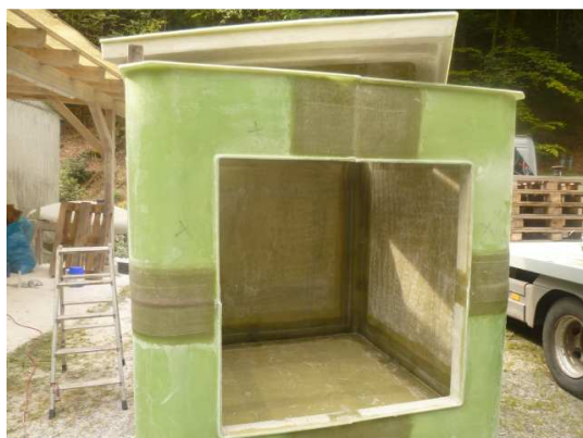
Bild II.7 Seitenwand für Austauschmodul
