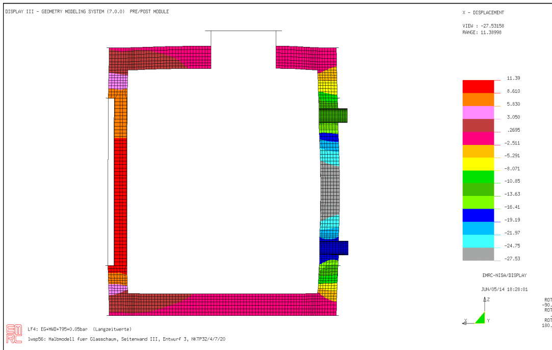
TB4.Bild 33: Verformung u_x [mm] maßstäblich (Vertikalschnitt). Darstellung ohne Glasschaum
