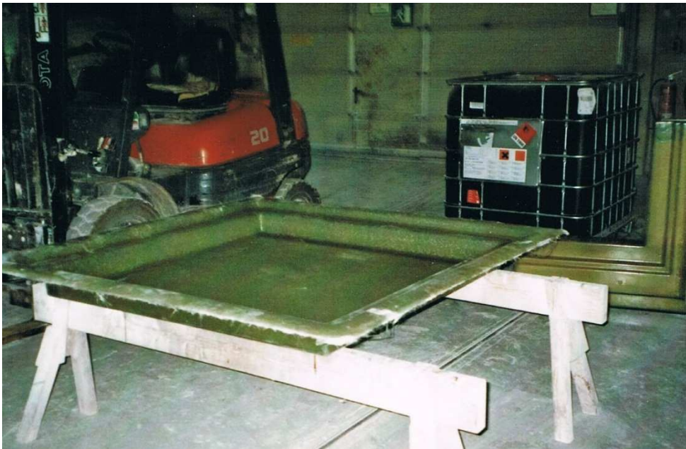
Abb. 3.11 Entformte Außenschale für Boden- bzw. Deckelmodul
