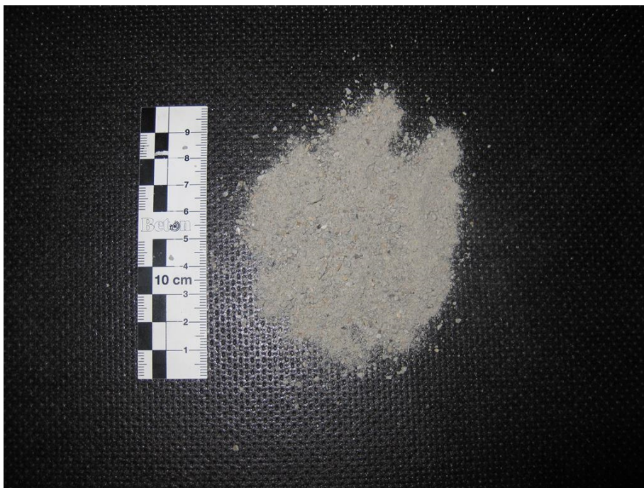
Abb. 39: Fraktion < 2 mm der elektrodynamisch aufbereiteten Gesteinskörnung aus Beton mit CEM I und quarzitischer Gesteinskörnung (Kies/Sand).
