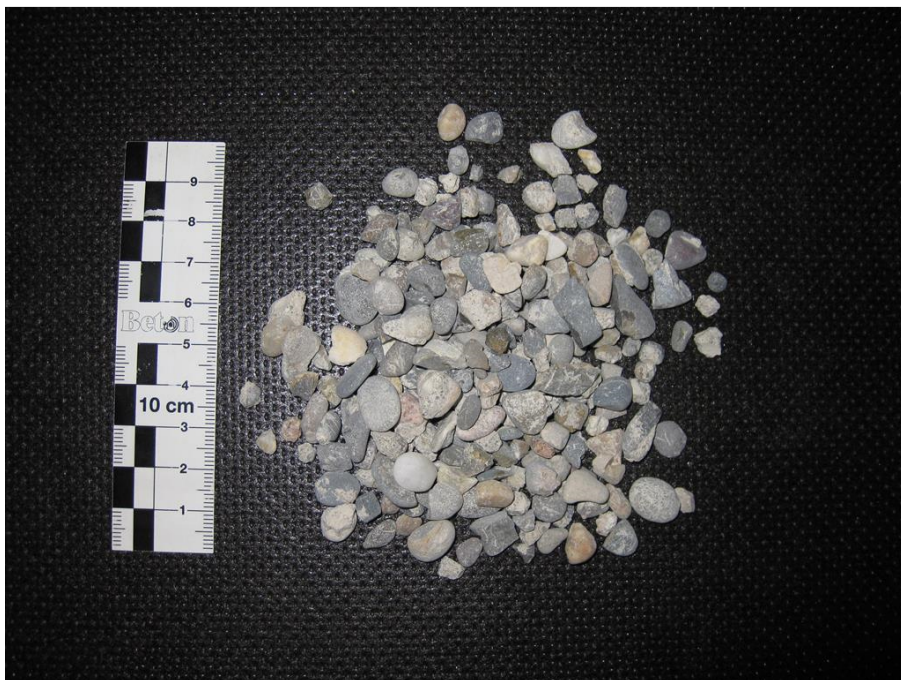
Abb. 37: Fraktion 5 - 10 mm der elektrodynamisch aufbereiteten Gesteinskörnung aus Beton mit CEM I und quarzitischer Gesteinskörnung (Kies/Sand).
