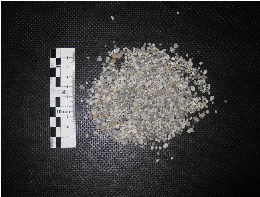
Abb. 38: Fraktion 2 – 5 mm der elektrodynamisch aufbereiteten Gesteinskörnung aus Beton mit CEM I und quarzitischer Gesteinskörnung (Kies/Sand).
