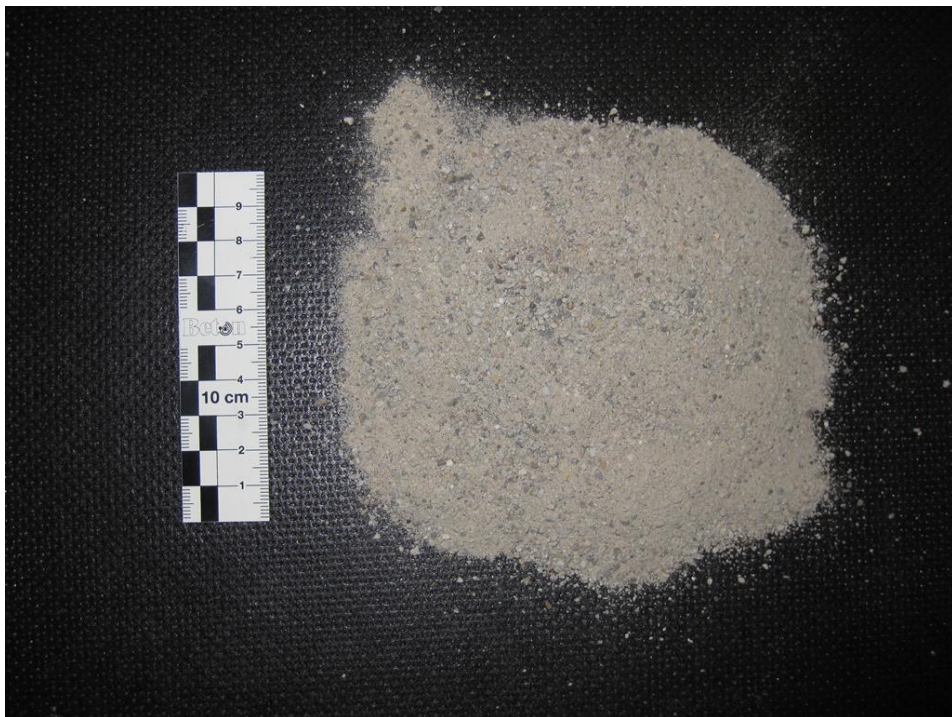
Abb. 41: Fraktion < 2 mm der mechanisch aufbereiteten Gesteinskörnung aus Beton mit CEM I und quarzitischer Gesteinskörnung (Kies/Sand).
