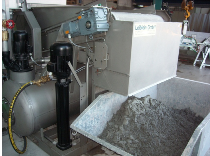
Abb 18: Dosiereinrichtung für Fällungsmittel und Feststoffabscheider für Prozesswasser.
