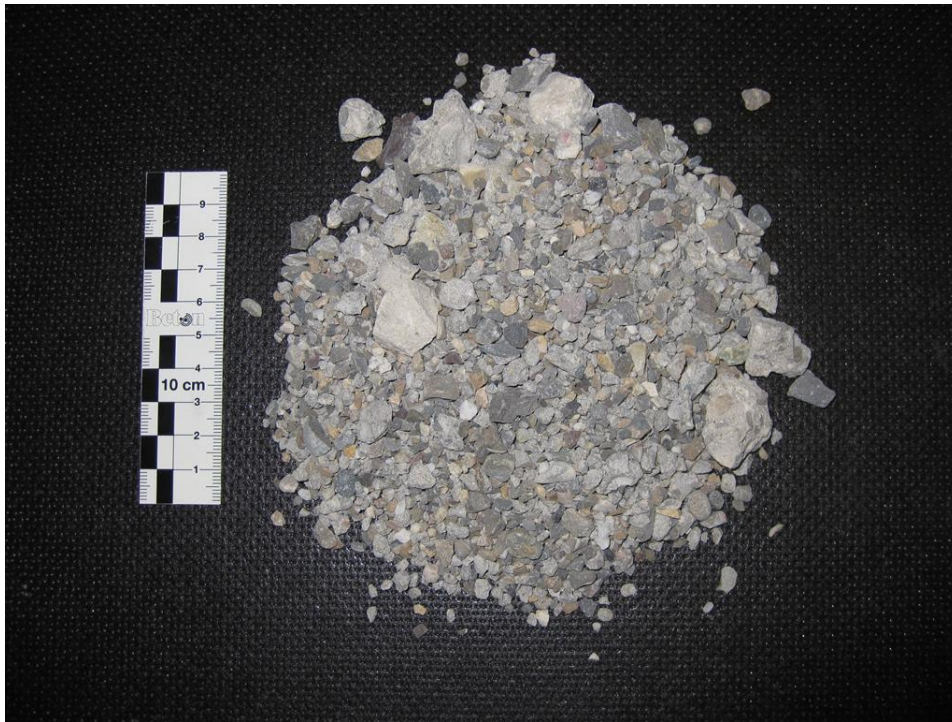
Abb. 40: Fraktion 2 - 8 mm der mechanisch aufbereiteten Gesteinskörnung aus Beton mit CEM I und quarzitischer Gesteinskörnung (Kies/Sand).
