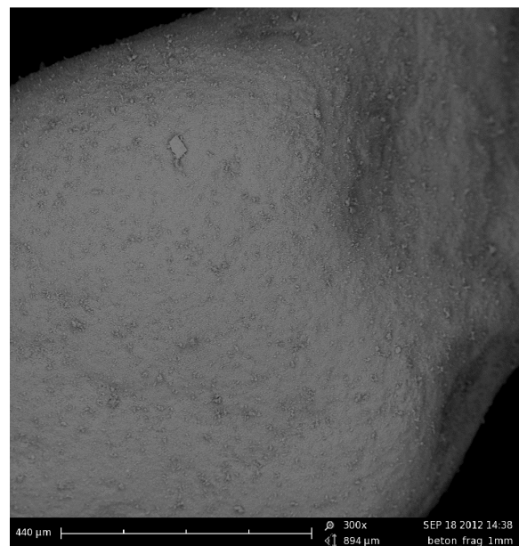
Abb. 4: linkes Bild: mechanisch gebrochener Altbeton, es sind noch deutlich Anhaftungen von Zementstein auf Kies zu erkennen, rechtes Bild: fragmentierter Altbeton, die Kiesoberfläche ist frei von Zementstein, es konnte lediglich Portlandit ( \text{Ca}(\text{OH})_2 ) nachgewiesen werden.
