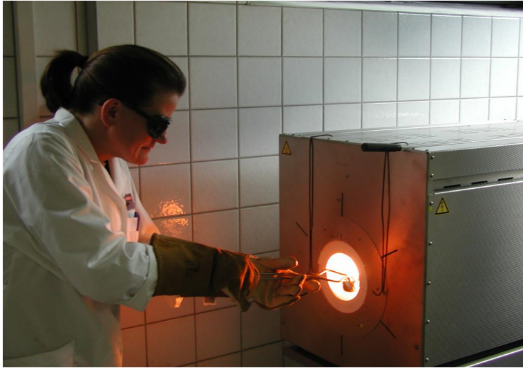
Abb. 12: Klinkerbrand im Laborofen, 15 min bei 1.450°C. [Quelle: SCHWENK]
