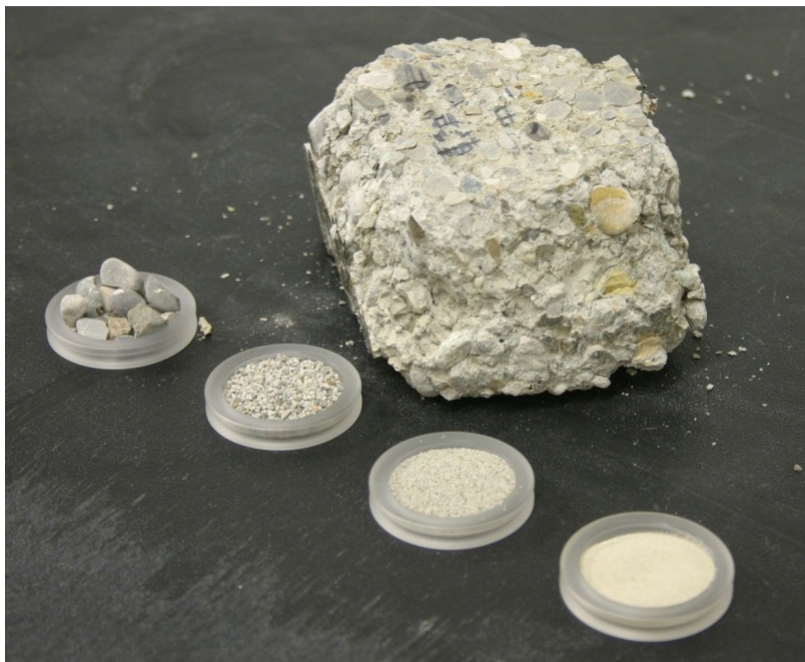
Abb. 3: Altbeton vor und nach einer elektrodynamischen Fragmentierung.
