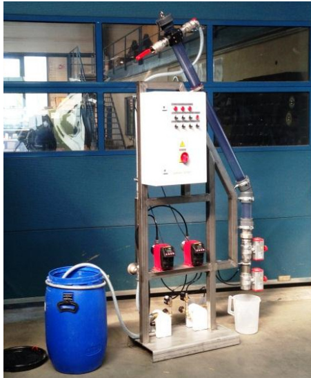
Abb 18: Dosiereinrichtung für Fällungsmittel und Feststoffabscheider für Prozesswasser.
