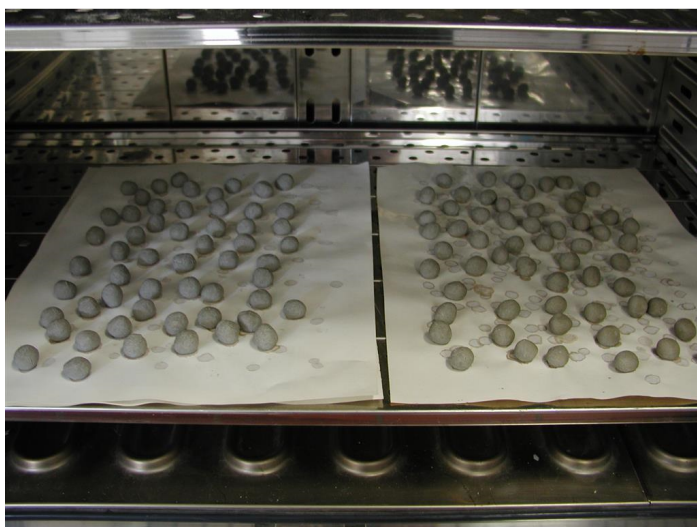
Abb. 11: Formen der Klinkergranalien und vortrocknen bei 105°C. [Quelle: SCHWENK]
