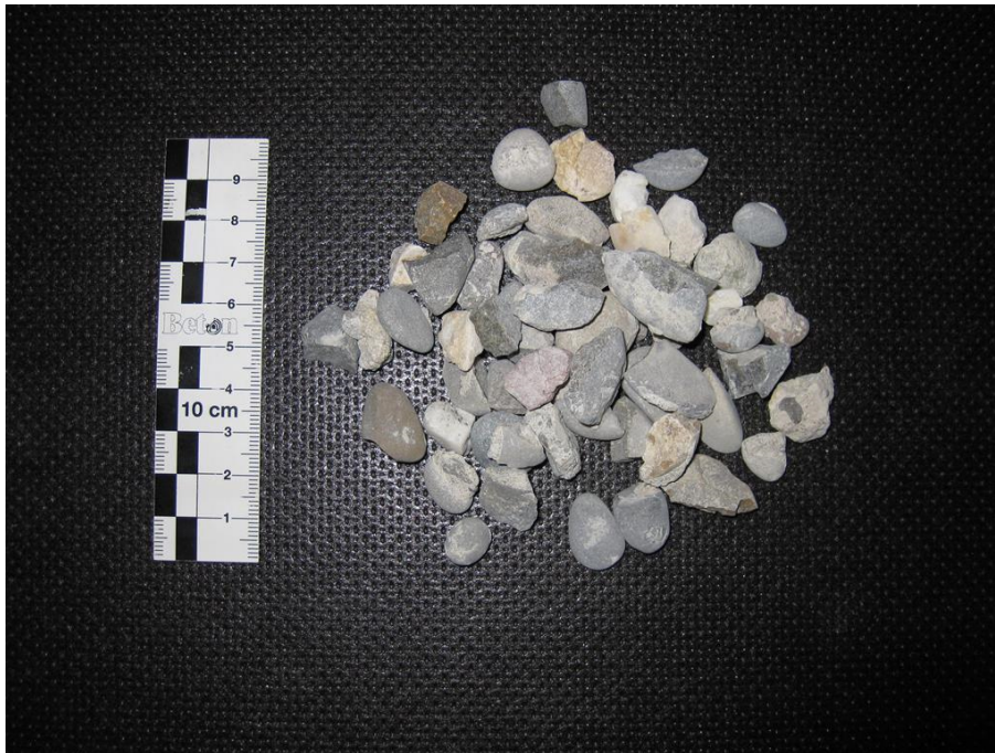
Abb. 36: Fraktion 10 - 15 mm der elektrodynamisch aufbereiteten Gesteinskörnung aus Beton mit CEM I und quarzitischer Gesteinskörnung (Kies/Sand).
