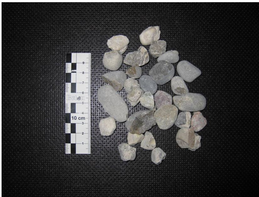
Abb. 35: Fraktion 15 - 20 mm der elektrodynamisch aufbereiteten Gesteinskörnung aus Beton mit CEM I und quarzitischer Gesteinskörnung (Kies/Sand).
