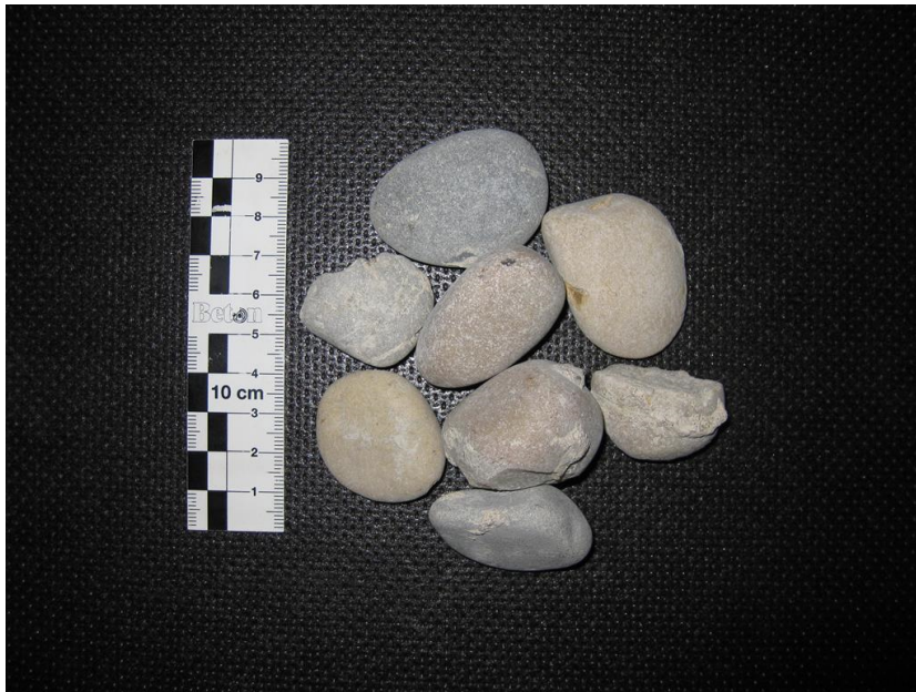
Abb. 34: Fraktion > 20 mm der elektrodynamisch aufbereiteten Gesteinskörnung aus Beton mit CEM I und quarzitischer Gesteinskörnung (Kies/Sand).
