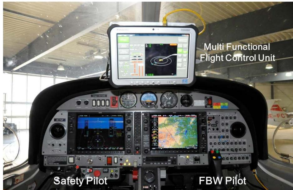
Abb. 2-17: Cockpit Ausrüstung des Erprobungsträgers DA42 mit zusätzlicher Multi Functional Flight Control Unit. (links – Sicherheitspilot, rechts – FBW-Pilot)
