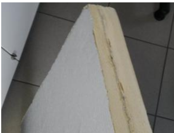
Abbildung 50: Paneel in einer Doppelbandanlage eingeschäumt links und Paneel im Laborwerkzeug eingeschäumt rechts
