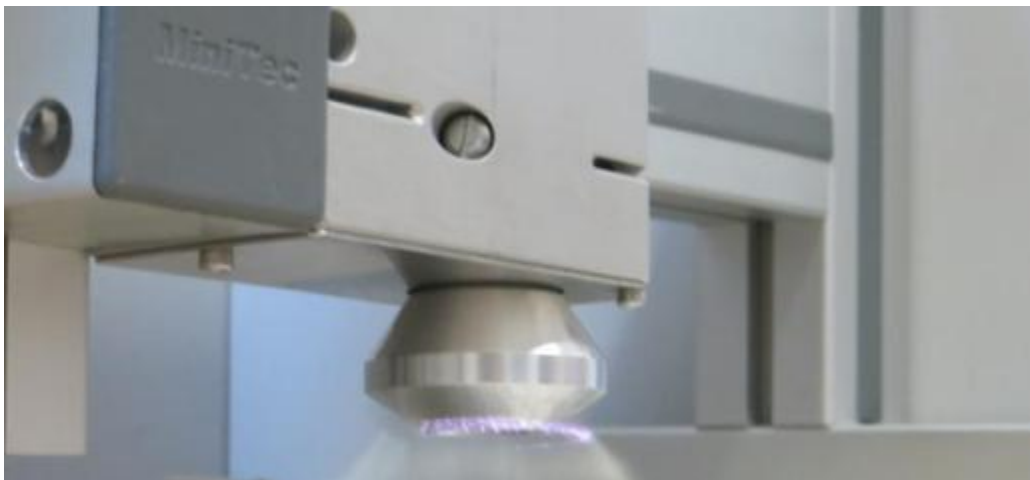
Abbildung 43: Rotationsdüse der Atmosphärendruckplasmaanlage
