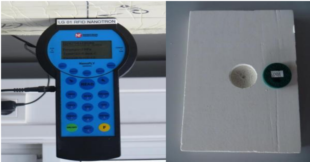
Abbildung 46: RFID - Auslesegerät links und RFID-Sensor mit Aussparung im Nano-Foam Kern rechts
