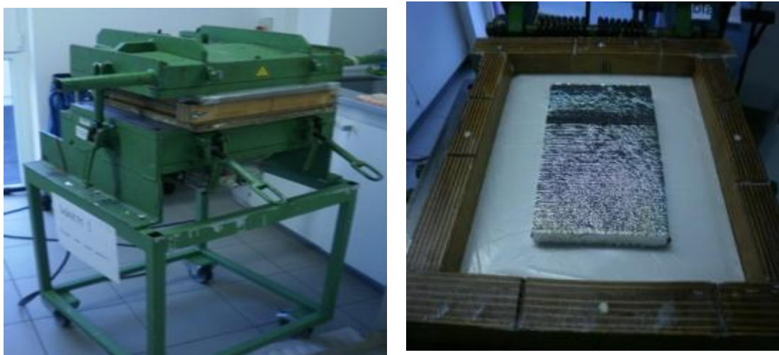
Abbildung 47: Laborwerkzeug links und beheizbare Schaumform mit eingelegtem VIP rechts
