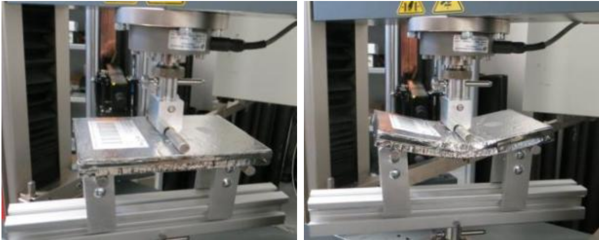
Abbildung 27: Biegeversuch eines Silica-Platte Panels in Anlehnung an die DIN EN ISO 178 (links vor und rechts während der Belastung)
