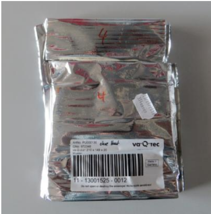
Abbildung 22: Silica-Platte Paneel nach dem Kurzzeitzugversuch
