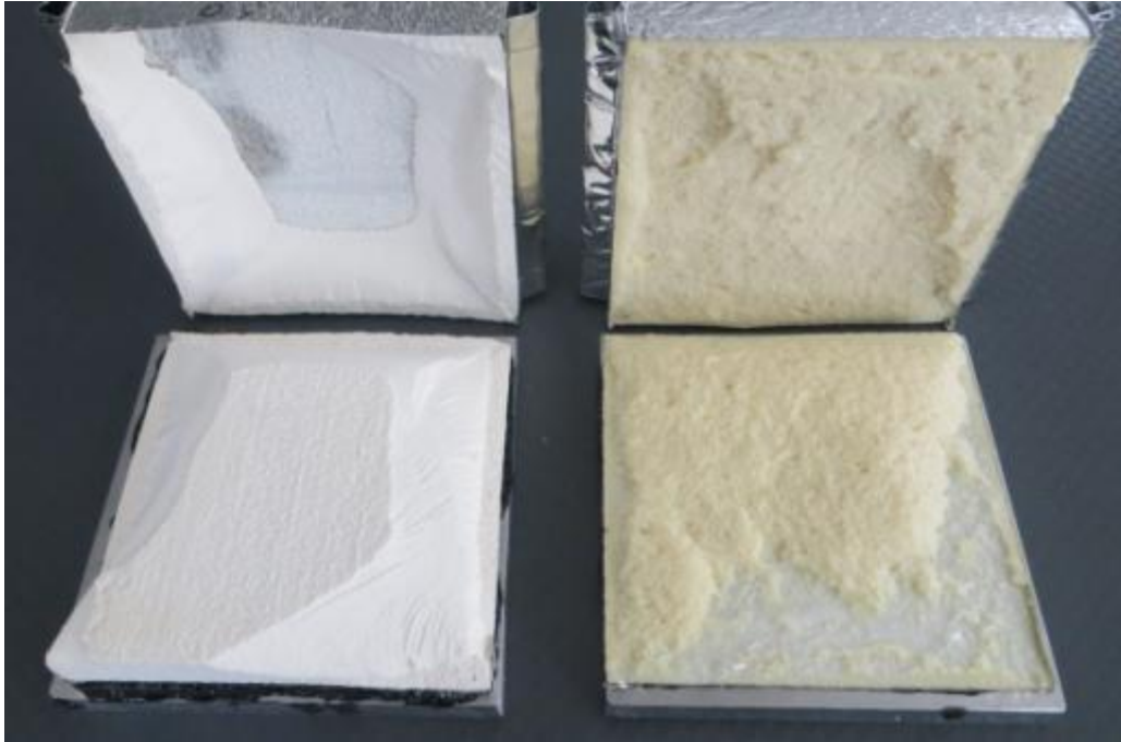
Abbildung 38: Ober- und Unterseite seitlich aufgeschnittener Nano-Foam links und PUR-Standard Paneele rechts nach der Zugprüfung
