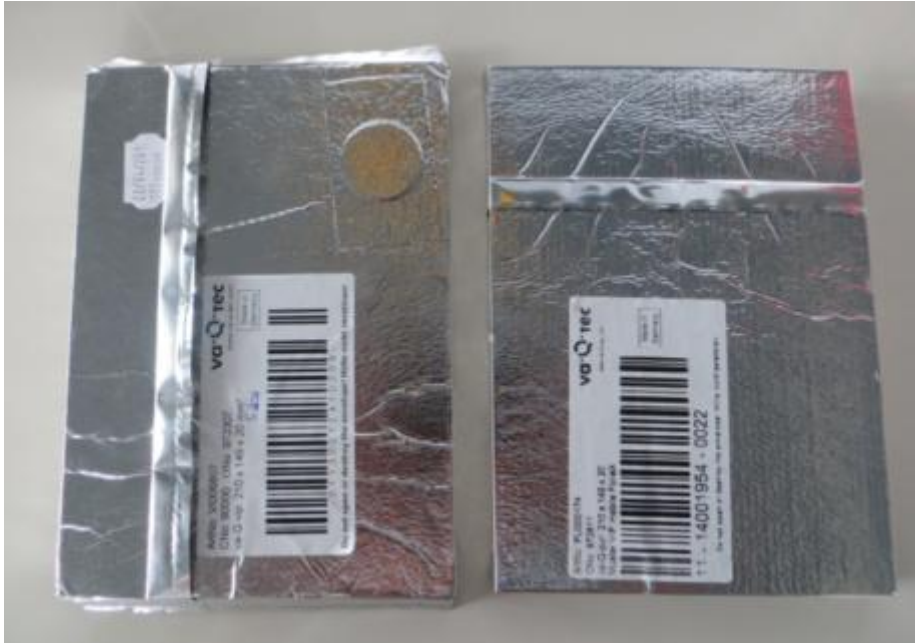
Abbildung 24: Längs zur Zugbeanspruchung liegende Siegelnaht (Naht längs) links im Bild und quer zur Zugbeanspruchung liegende Siegelnaht (Naht quer) rechts im Bild
