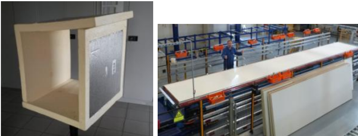
Abbildung 71: Eingeschäumte Eckstruktur links sowie ein großes anwendungsnahes Paneel rechts
