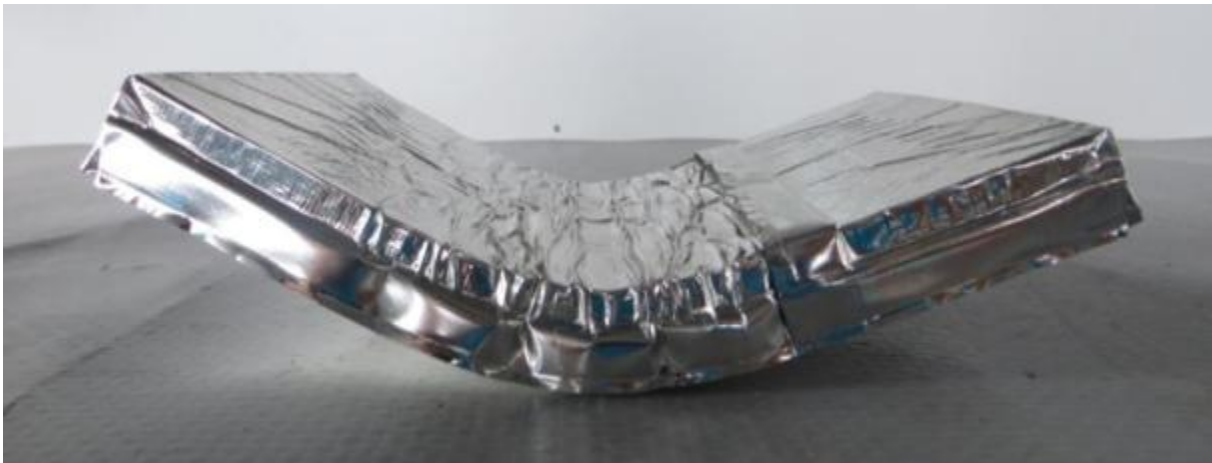
Abbildung 28: Bleibende Verformung des Silica-Platte Panels nach dem Biegeversuch
