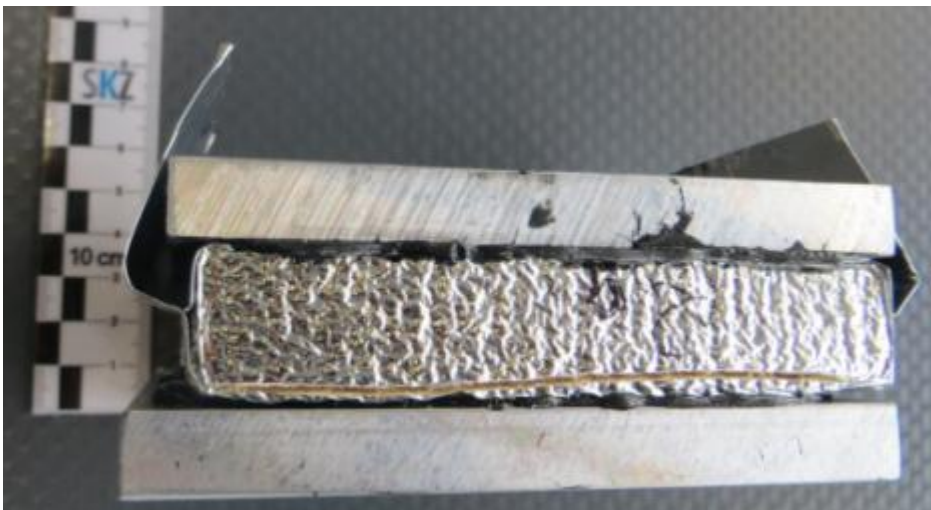
Abbildung 37: PUR-Standard Paneel, dass seitlich aufgeschnitten wurde
