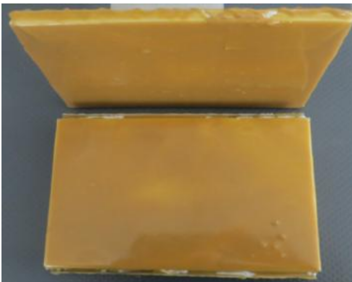
Abbildung 63: Eingegossenes Paneel mit einem Polyurethan-Gießharz System
