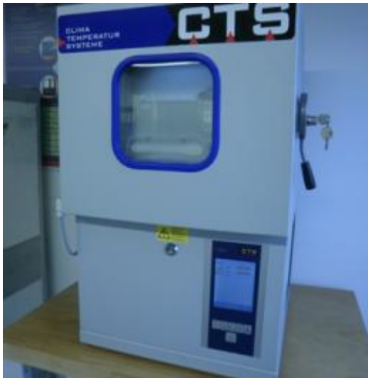
Abbildung 32: Klimakammer zur Auslagerung
