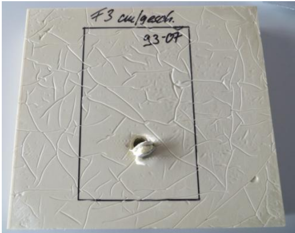
Abbildung 56: Unterseite eines eingeschäumten PUR-Standard Paneels nach der Prüfung
