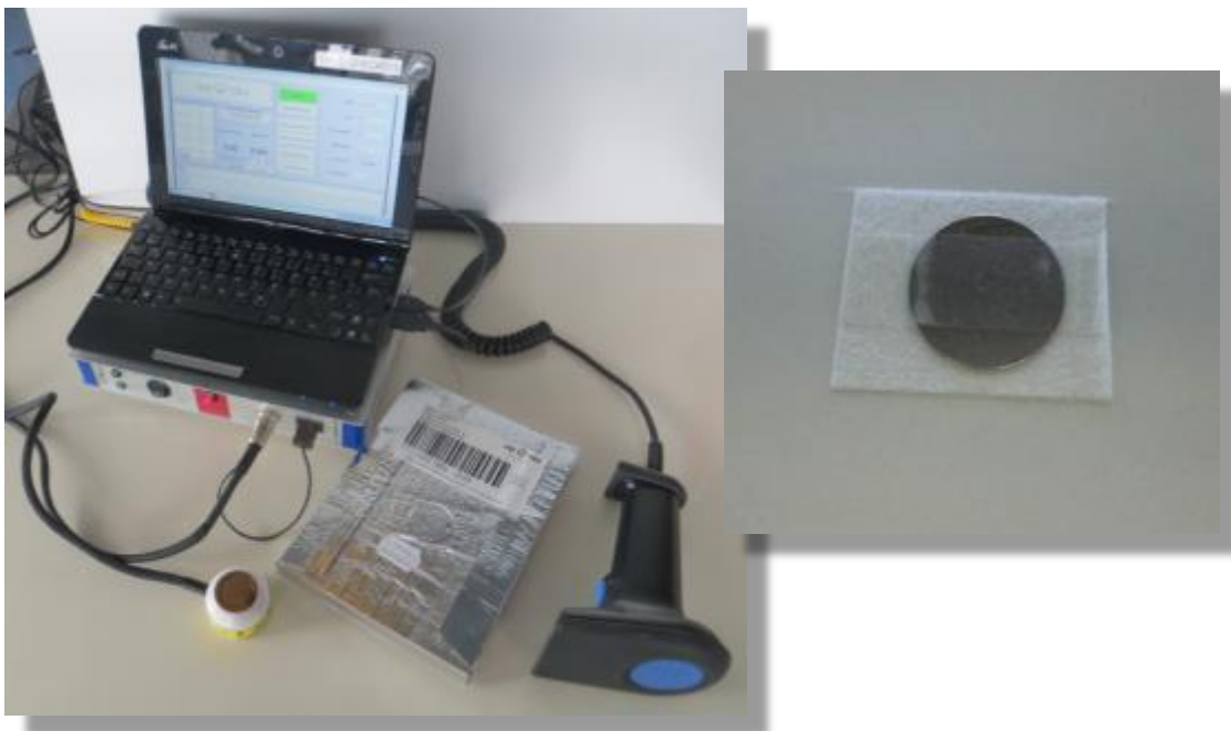
Abbildung 4: Va-Q-check Auslesegerät links und va-Q-check Sensor auf einem PUR-Standard Paneel rechts im Bild
