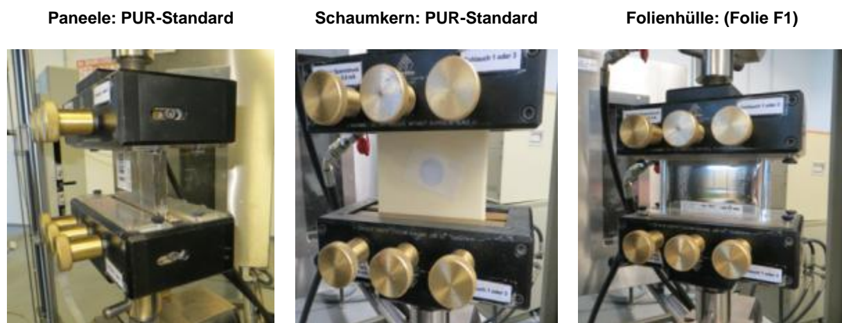
Abbildung 20: Eingespanntes Paneel links, Kernmaterial Mitte und Folienhülle rechts
