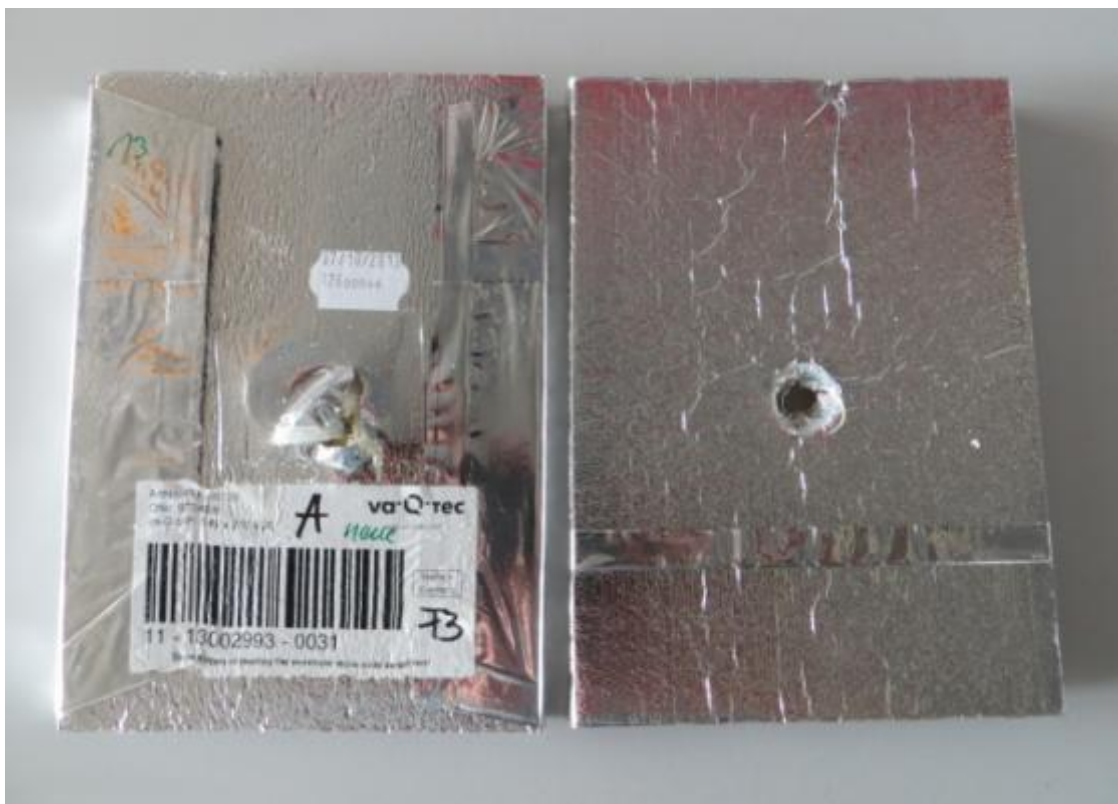
Abbildung 31: Unterseite links und Oberseite rechts eines PUR-Standard Paneels nach der Prüfung
