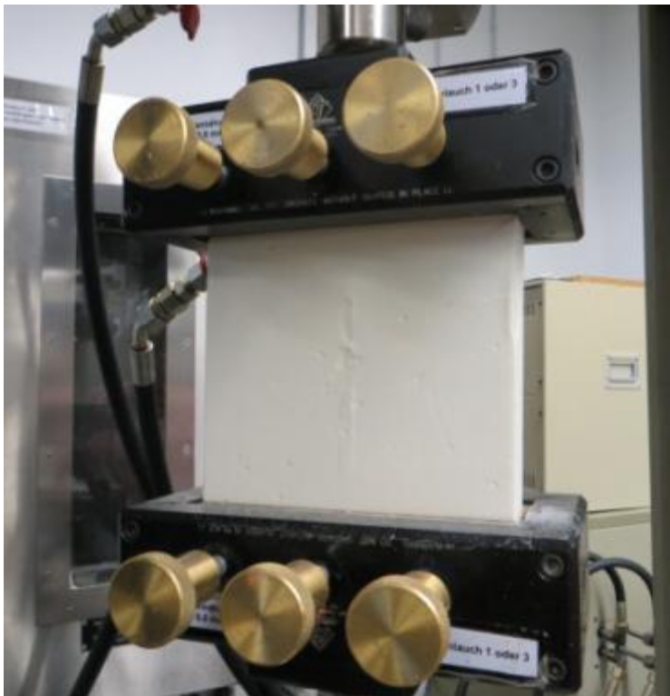
Abbildung 51: Eingeschäumtes PUR-Standard Paneel in einer Zugprüfmaschine
