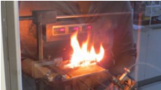
Abbildung 73: Abbrennender Schaumproben in der Brandkammer
