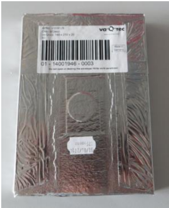
Abbildung 49: PUR-Standard Paneel mit seitlich umgelegter Siegelnaht (lange Lasche)
