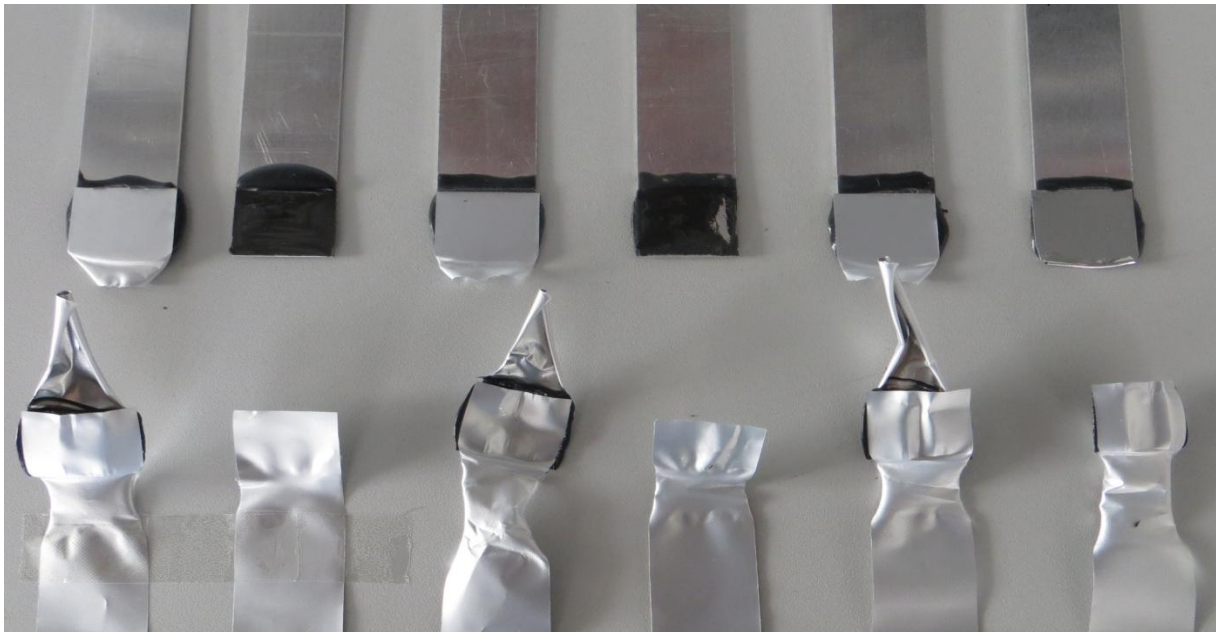
Abbildung 45: Bruchbilder der vorbehandelten sowie unvorbehandelten Folie-Metall Klebungen
