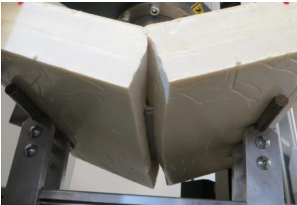
Abbildung 54: Gebrochenes, eingeschäumtes Paneel nach Abbruch der Biegeprüfung
