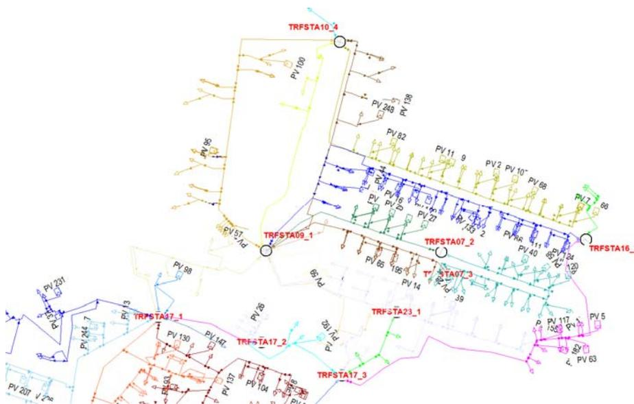
**Abbildung 113: Ausschnitt des 0,4 kV Netz aus Abbildung 88 mit einem Teil der 250 PV-Systemen an zufällig ausgewählten Anschlusspunkten von Lasten.**
