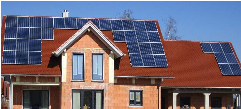
Abbildung 90: PV-System mit 40 PV-Panels vom Typ Trina 250 Wp [37].
