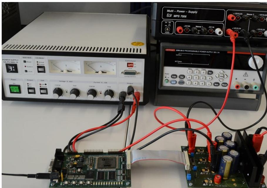
**Bild 57: DSP-Board, Endstufe und Spannungsversorgung**
