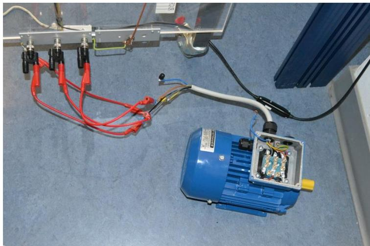
**Bild 66: Kommerzieller dreiphasiger Asynchronmotor Vathauer GM71/4 0.73 kW**
