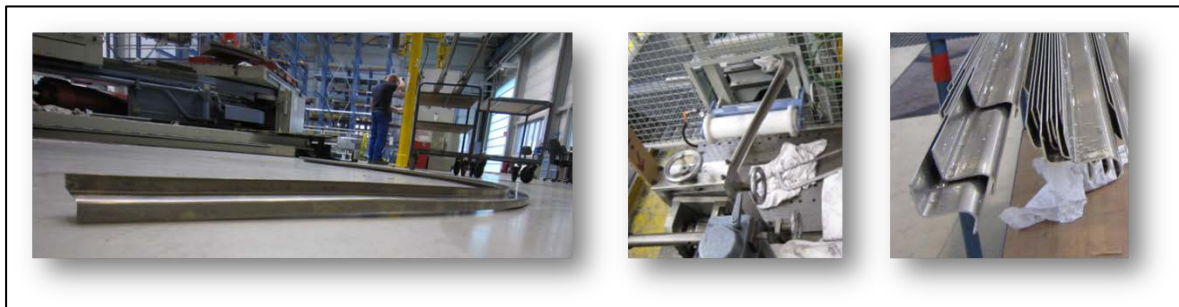
Abbildung 2.1-2: Roll-Form-Arbeiten an Standard-AlMgSc-Material (Spant und Stringer)
