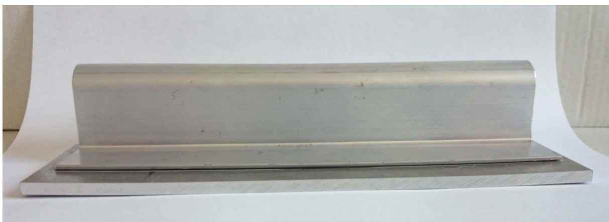
Abbildung 2.5-7: Umgeformt und gleichzeitig verklebter Demonstrator einer Klebeverbindung eines Stringers auf einem Flugzeugrumpffpanel.
