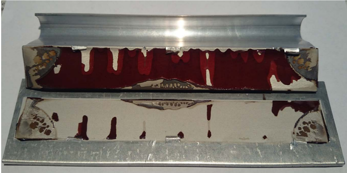
Abbildung 2.5-8: Bruchflächen der Stringerprobe nach dem Trennen
