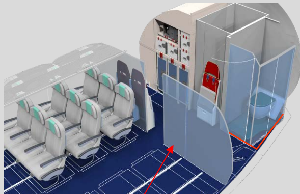
PRM Lavatory beim „Spaceflex Konzept“ mit geschlossener Partition und Tür
