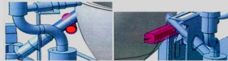
Abbildung 7.17: Elektrische Bewegung: Zahnstangengetriebe (links), Gehäuse (rechts)
