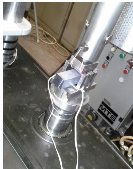
Bild II-13: Quasi-mono-Si-Stab mit appliziertem DMS zum Test in einer 4-Linien Biegeapparatur.
