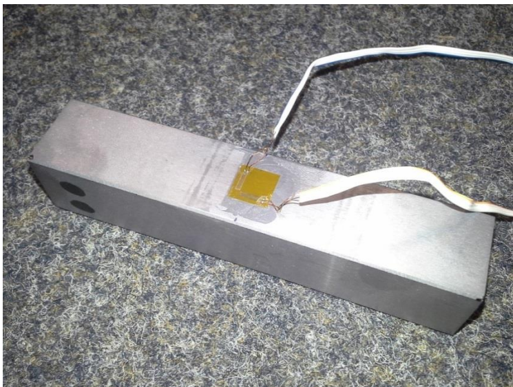
Bild II-13: Quasi-mono-Si-Stab mit appliziertem DMS zum Test in einer 4-Linien Biegeapparatur.
