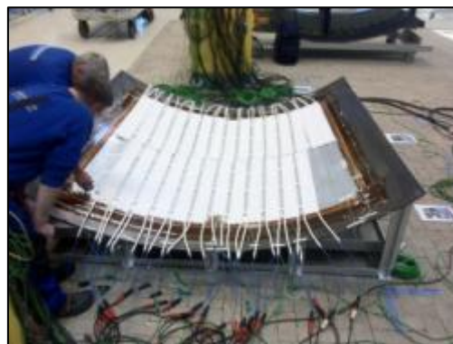
Abbildung 15: Auflegen der Heizmatten
