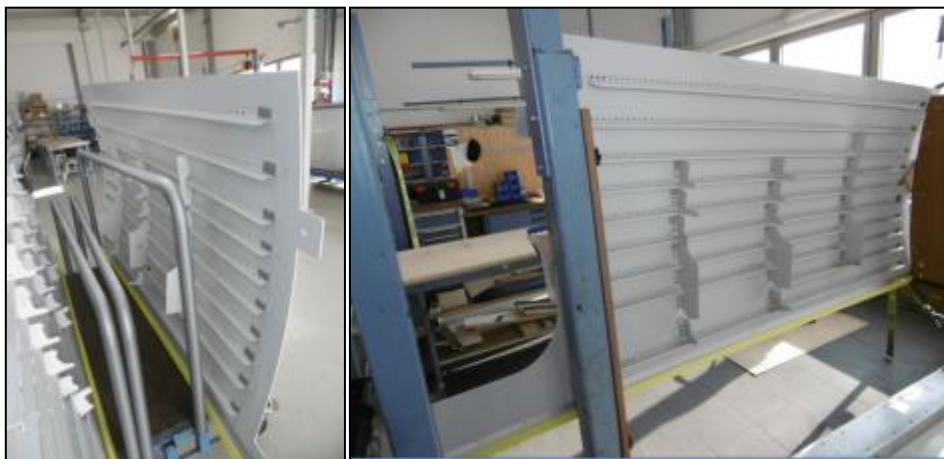
Abbildung 47: Fertigstellung der zwei Hautfeldsegmente
