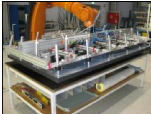
Abbildung 52: Dünnsblechhandler (Endeffektor) mit der Abmessung 2m x 1m.
